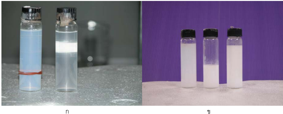
รูป 4.30 ลักษณะสารตัวอย่างภายหลังการสังเคราะห์แบบ Admicellar polymerization ที่ความเข้มข้นสไตรีนน้อย (ก) และที่ความเข้มข้นสูง (ข)
