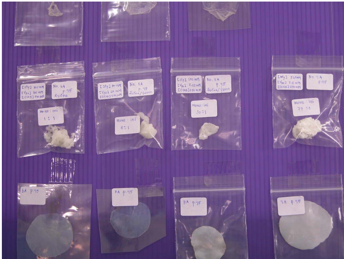
รูป 4.33 (แถวบน) ยางแกนเปลือกพอลิสไตรีน หลังอบแห้ง เตรียมที่ภาวะ [styrene] 50 mM โดย mole ratio ของ styrene:V50 = 1:1 5:1 30:1 และ 77:1 (แถวล่าง) หลังจากนำไปกดอัด
