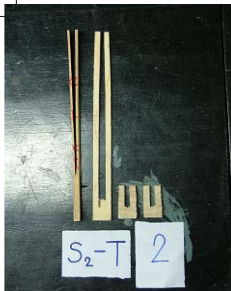
รูปผนวกที่ 18 การทดสอบ Prong test ของชิ้นทดสอบ S2-T2
