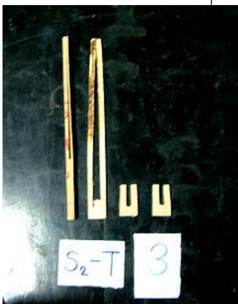
รูปผนวกที่ 19 การทดสอบ Prong test ของชิ้นทดสอบ S2-T3
