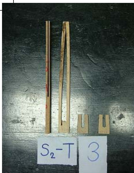
รูปผนวกที่ 19 การทดสอบ Prong test ของชิ้นทดสอบ S2-T3
