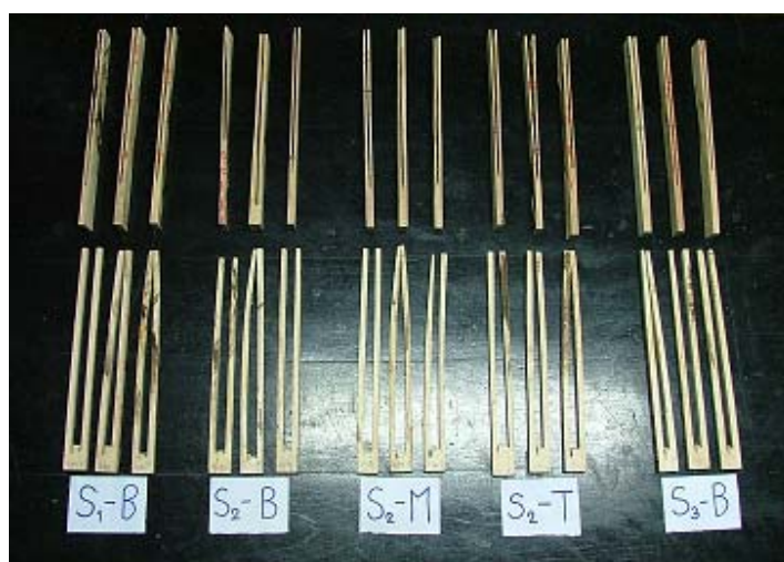
รูปผนวกที่ 7 การทดสอบความเค้นหลังจากทิ้งไว้ที่อุณหภูมิห้อง 24 ชั่วโมง
