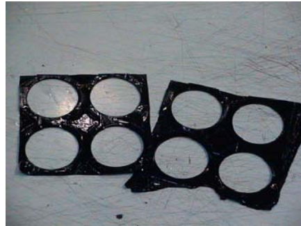
รูปที่ 11 ครีบชิ้นงานหลังการกดตัด
