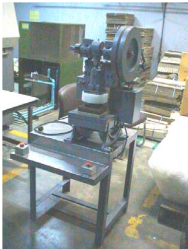
รูปที่ 13 เครื่องกดตัดที่ได้รับการพัฒนา และปรับปรุง
