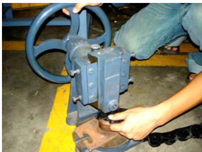
รูปที่ 5.3 การนำแม่ขึ้นงานยางมาอัดใส่เบ้าของเครื่องจักรแบบเก่า
