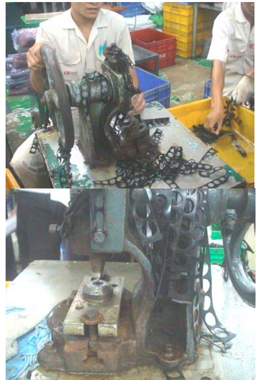
รูปที่ 1 เครื่องกดตัด (Die-Punch) ที่ใช้อยู่ในโรงงานผลิตผลิตภัณฑ์ยาง (บริษัท เอส เค โพลีเมอร์ จำกัด)
