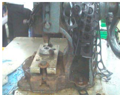
รูปที่ 1.1 เครื่องกดตัด (Die-Punch) ที่ใช้อยู่ในโรงงานผลิตภัณฑ์ยาง ( บริษัท เอส เค โพลีเมอร์ จำกัด )
