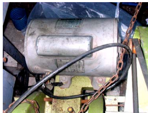
รูปที่ 3.9 มอเตอร์ AC ขนาด 0.50 แรงม้า 220 โวลต์
