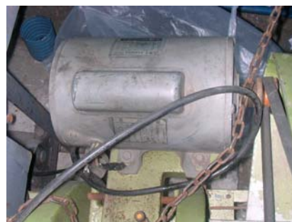
รูปที่ 8 มอเตอร์ขนาด 0.50 แรงม้า 220 โวลต์
