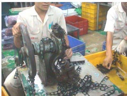
รูปที่ 1.1 เครื่องกดตัด (Die-Punch) ที่ใช้อยู่ในโรงงานผลิตภัณฑ์ยาง ( บริษัท เอส เค โพลีเมอร์ จำกัด )
