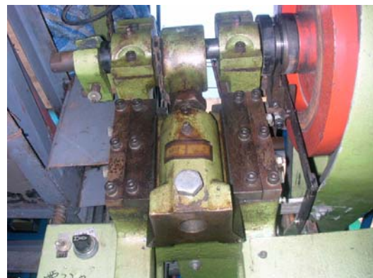
รูปที่ 2 แสดงชุดปั๊มกดแบบ 2 ปุ่ม
