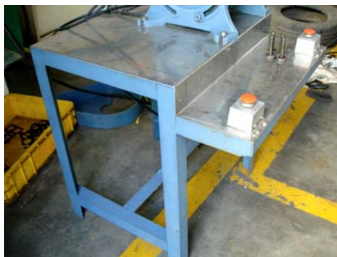
รูปที่ 3.10 ฐานเครื่องจักรที่หุ้มด้วยแผ่นสแตนเลส
