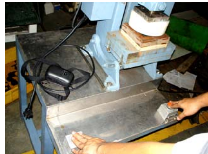
รูปที่ 5.6 การกดตัดชิ้นงานยางของเครื่องจักรแบบที่ได้รับการปรับปรุงพัฒนาแล้ว
