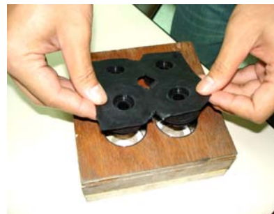
รูปที่ 5.4 การนำแม่ขึ้นงานยางมาอัดใส่เบ้าของเครื่องจักรแบบที่ได้รับการปรับปรุงและพัฒนาแล้ว
