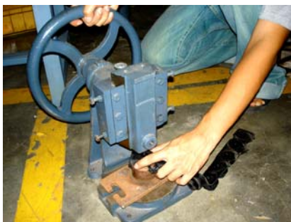
รูปที่ 5.5 การกดตัดชิ้นงานยางของเครื่องแบบเก่า
