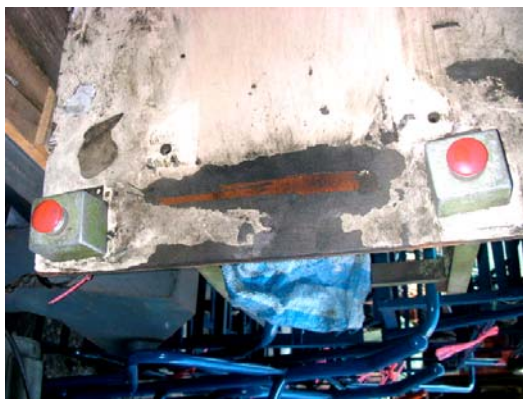
รูปที่ 3.1 แสดงชุดปั๊มกดแบบ 2 ปุ่ม
