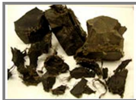
รูปที่ 2.2 แสดงเศษชิ้นส่วนยางที่ผ่านการย่อย โดยเครื่องย่อยตัดใบมีด [5]
