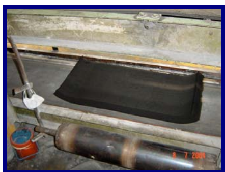
รูปที่ 2.18 ยางที่ถูกอัดให้เป็นยางแผ่น
