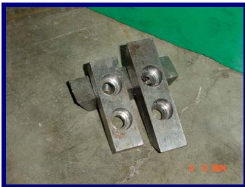
รูปที่ 4.5 ไบมิดก่อนการเจียระไนลับคม และการชุบแข็ง
