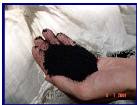
รูปที่ 2.15 เศษยางที่ผ่านกระบวนการแยกผ้าใบโดยเครื่องไซโคลน
