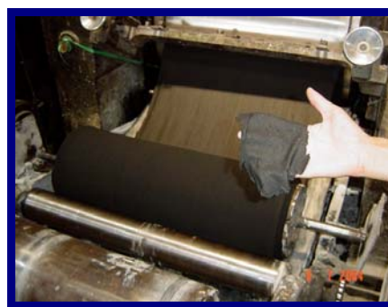
รูปที่ 2.17 การรีดยางให้เป็นแผ่น
