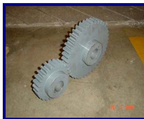
รูปที่ 4.11 ชุดเฟืองส่งกำลังเฟืองขับขนาด 24 ฟัน ขนาด 20 และ 23 ฟัน ตามลำดับ และเฟืองตามขนาด 40 ฟัน
