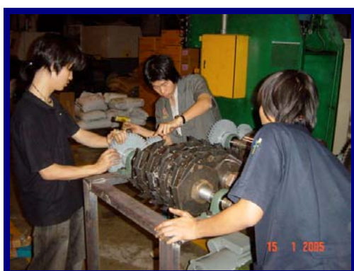
รูปที่ 4.17 การตั้งเพลลาพร้อมแบร์ริงบนฐาน
