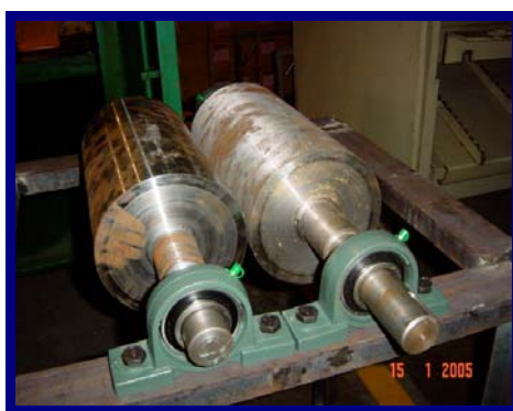
รูปที่ 4.19 ชุดลูกกลิ้งบดตั้งบนฐานสมบูรณ์
