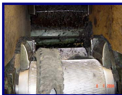
รูปที่ 2.10 ยางที่กำลังถูกย่อยและเศษยางที่ไม่ได้ขนาดแล้วถูกลำเลียงกลับมาย่อยครั้งต่อไป
