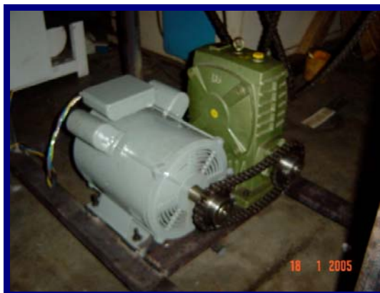
รูปที่ 4.9 มอเตอร์ขนาด 10 แรงม้าและชุดทดเกียร์ขนาด 10:1
