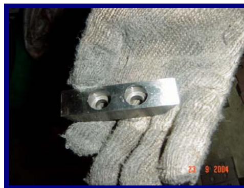
รูปที่ 4.6 ไบมิดหลังการเจียระไนลับคม และการชุบแข็ง
