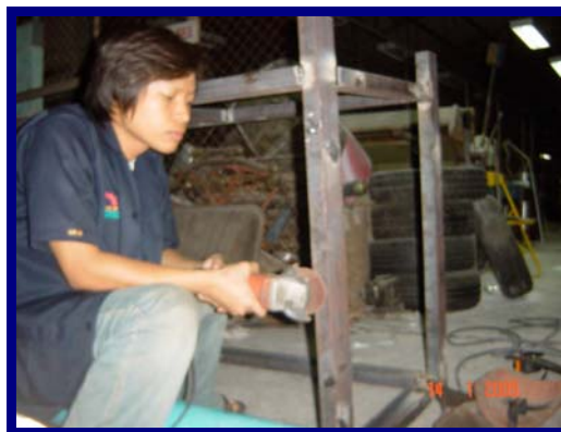
รูปที่ 4.8 การเจียรระไนสะเก็ดจากการเชื่อม
