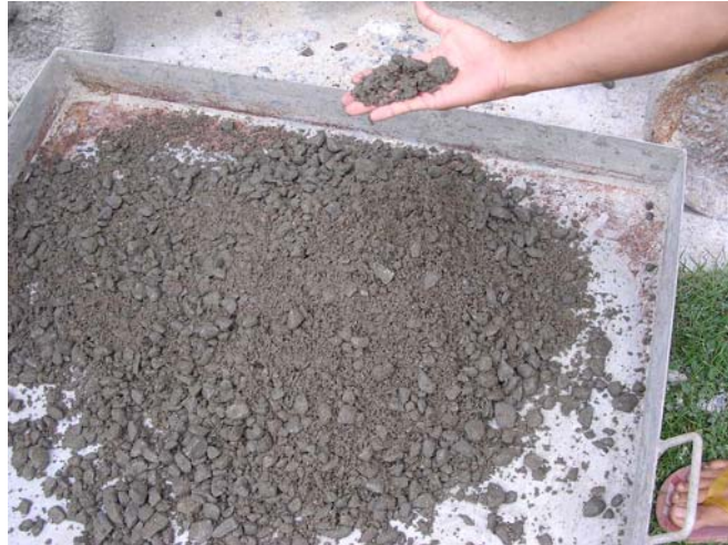
รูปที่ 4.1 ลักษณะของคอนกรีตผสมน้ำยาง สัดส่วน P/C = 0.05 ที่ขาดความสามารถเทได้
