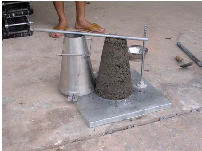
รูปที่ 4.2 คอนกรีตผสมน้ำยาง สัดส่วน P/C = 0.05 มีค่า Slump = 0
