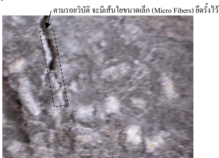
รูปที่ 4.8 คอนกรีตสัดส่วน W/C = 0.4 ผสมน้ำยาง P/C = 0.25
