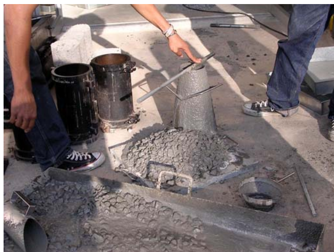
รูปที่ 4.6 คอนกรีตสดสัดส่วน W/C = 0.4 ผสมน้ำยาง และสารลดแรงตึงผิว ทำให้เกิดการยุบตัวแบบสวบ
