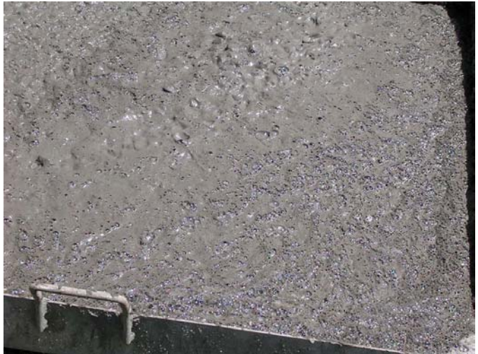
รูปที่ 2 ฟองอากาศจำนวนมากในคอนกรีตที่ W/C = 0.6 ผสมน้ำยาง
