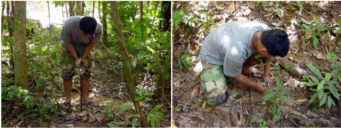
ภาพที่ 2-15: การวัดความคงทนของดินต่อการเหยียบย่ำ และความยืดหยุ่นของเนื้อดิน
