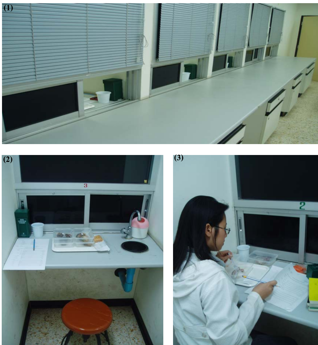
รูปที่ 4.2 การจัดรูปแบบการทดสอบทางประสาทสัมผัสของ; (1) คือ ห้องปฏิบัติการทดสอบทางประสาทสัมผัส; (2) คือ การจัดชุดตัวอย่างสำหรับการทดสอบทางประสาทสัมผัส และ (3) คือ ลักษณะการทดสอบทางประสาทสัมผัสของผู้ทดสอบชิม
