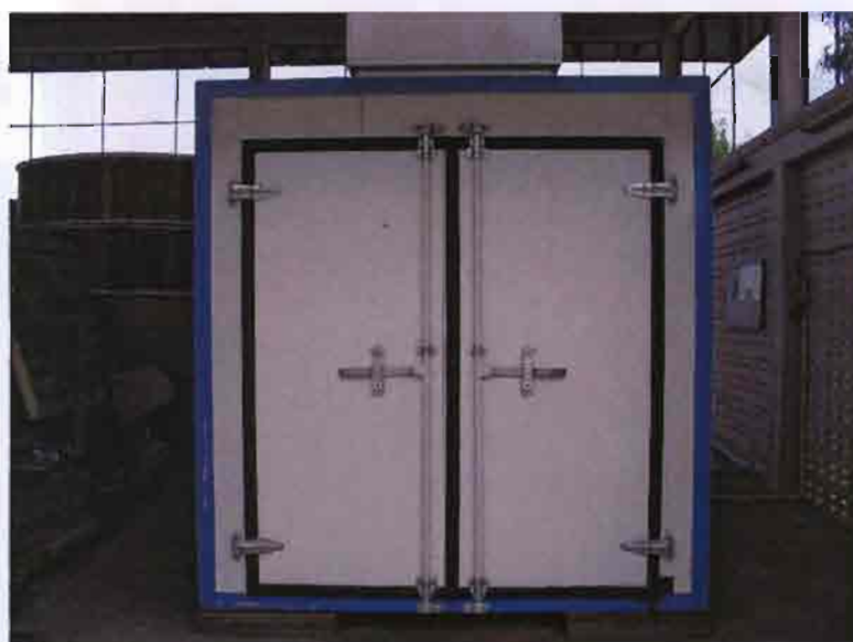
ภาพที่ 24 ตู้รม \text{SO}_2 ผลลำไยสดขนาด 10 ลูกบาศก์เมตร
