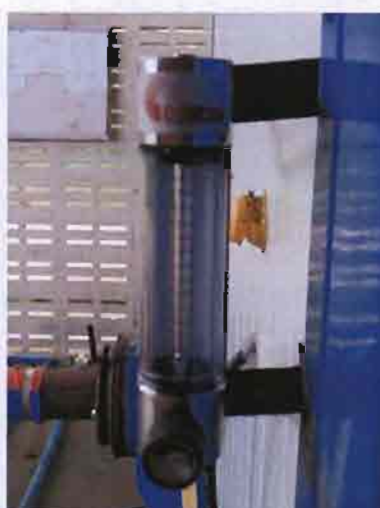
ภาพที่ 27 การนำแก๊ส \text{SO}_2 จากถังอัดความดันโดยตรงผ่านชุดควบคุมอัตราการไหลของแก๊ส \text{SO}_2 เข้าสู่ตู้อรม
