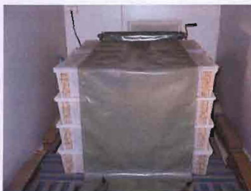
ภาพที่ 32 การทดลองรรม \text{SO}_2 จากถังอัดความดัน โดยตรงกับผลล่ำไยสดที่บรรจุในตะกร่ำขาวด้วยระบบหมุนเวียนอากาศแบบ forced-air
