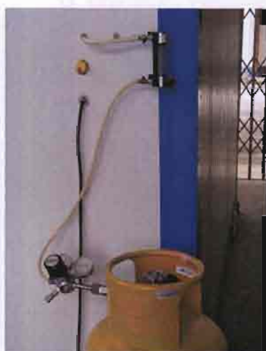
ภาพที่ 27 การนำแก๊ส \text{SO}_2 จากถังอัดความดันโดยตรงผ่านชุดควบคุมอัตราการไหลของแก๊ส \text{SO}_2 เข้าสู่ตู้อรม
