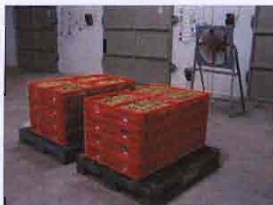
ภาพที่ 19 การใช้พัดลมเป่าไปยังตะกร้าบรรจุผลลำไยเพื่อป้องกันการดูดแก๊สต่อเนื่อง (carry over effect)
