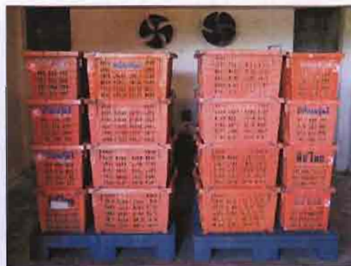
ภาพที่ 31 การทดลองรรม \text{SO}_2 จากการการเผาพวงำมะถันกับผลล่ำไยสดด้วยระบบหมุนเวียนอากาศแบบ forced-air (ซ้าย) เปรียบเทียบกับระบบหมุนเวียนอากาศแบบ circulating-air (ขวา) ของบริษัท พีชไทยฟรุต จ. ลำพูน
