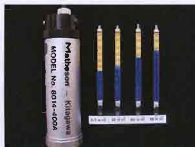
ภาพที่ 18 การตรวจสอบปริมาณ \text{SO}_2 ภายในห้องรมด้วย dosimeter tubes
