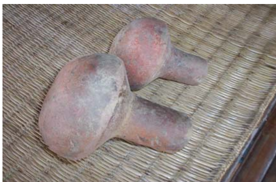
“ภาพที่ 59 หินดู อุปกรณ์ที่สำคัญในการปั้นหม้อ”
