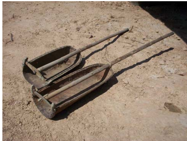
“ภาพที่ 63 คันโซ่ อุปกรณ์ใช้สำหรับวิดน้ำ”
