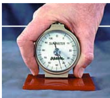
ภาพที่ 3-5 ดูโรมิเตอร์ที่ใช้วัดค่าความแข็ง
