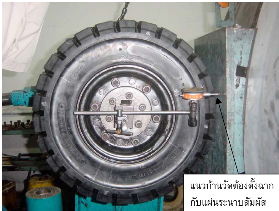
ภาพที่ 4-4 ล้อยางต้นในตำแหน่งที่สัมผัสกับแผ่นระนาบสัมผัส
