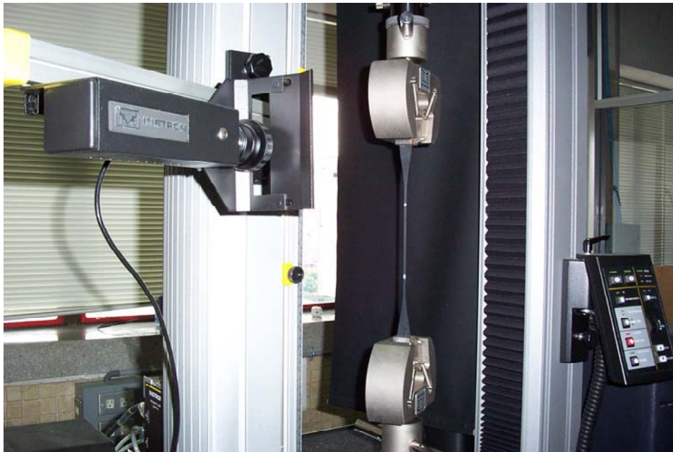
ภาพที่ 3-2 เครื่องทดสอบแรงดึงขณะทำการทดสอบ
