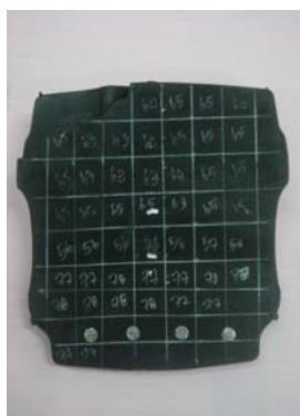
ภาพที่ 3-6 ชิ้นทดสอบค่าความแข็งที่เป็นส่วนหนึ่งของล้อยางตัน
