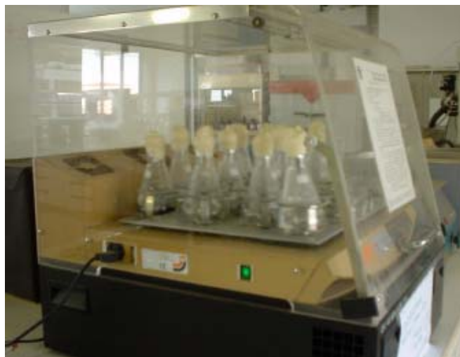
รูปที่ 5 ขวดรูปชมพู่บรรจุสารละลายและขึ้นยางบนเครื่องเขย่า
