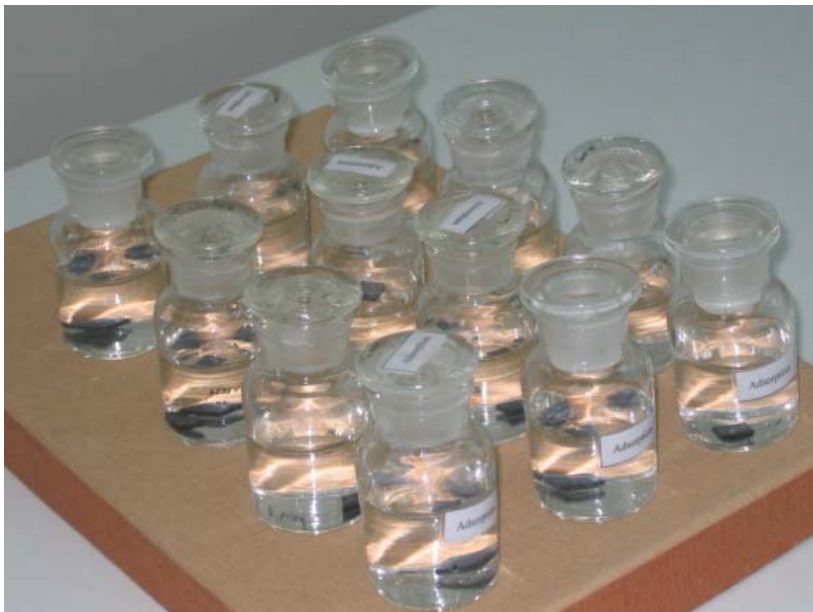
รูปที่ 4 ชันยางในขวดปิดใส่สารอินทรีย์บริสุทธิ์ ในภาพเป็นน้ำซึ่งใช้ปริมาณมากกว่า 15 ml. แต่สารอื่นจะใช้เพียง 15 ml. เท่านั้น
