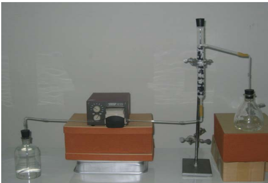
รูปที่ 6 หอดูดจับสารที่ประกอบขึ้นเองพร้อม Peristaltic ปัม สารจะถูกดูดจากภาชนะทางด้านซ้ายมือ เข้าทางด้านล่างของหอ แล้วออกทางด้านบนเข้าสู่ภาชนะเก็บสารละลาย
