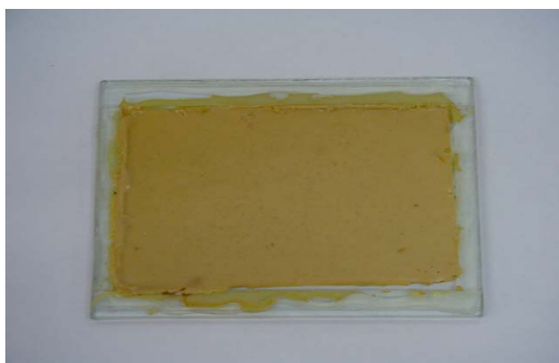
รูปที่ 4.13 ยางเหลวคอมปาวด์ที่เตรียมจากยางแท่งโดยใช้น้ำมันสปีนเดิล 200 phr และสารตัวเติม 75 phr หลังจากอบที่ 100°C 48 ชั่วโมง
