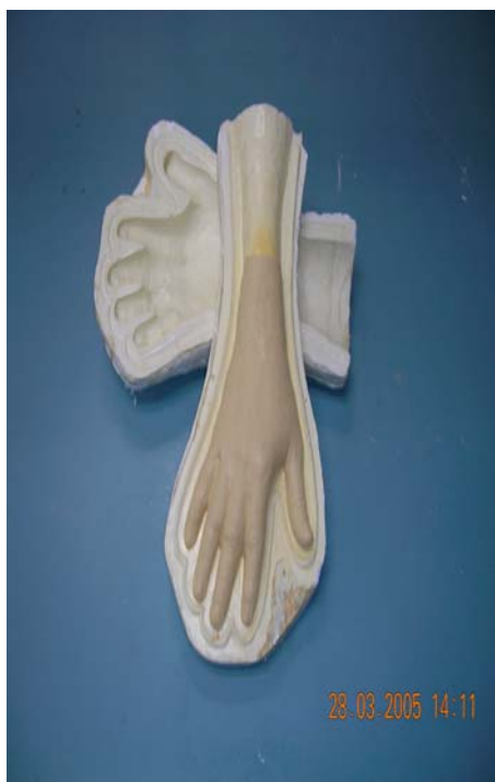
รูปที่ 3.18 ผลิตภัณฑ์ผิวหนังเทียมหลังจากนำไปอบเพื่อวัลคาไนซ์ที่ 50^{\circ}\text{C} 6 ชั่วโมง และ 70^{\circ}\text{C} 18 ชั่วโมง
