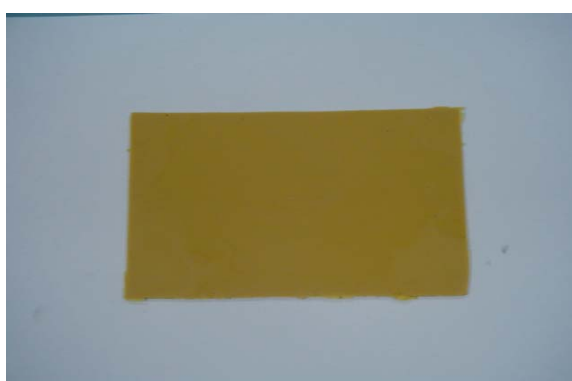
รูปที่ 4.15 ลักษณะของแผ่นยางเหลวคอมปาวด์ที่เตรียมจากน้ำยางข้น หลังการอบที่ 50°C 6 ชั่วโมง และ 70°C 12 ชั่วโมง
