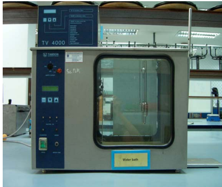
รูปที่ 3.3 การหาน้ำหนักโมเลกุลโดยวิธีวัดความหนืดของสารละลายยาง
