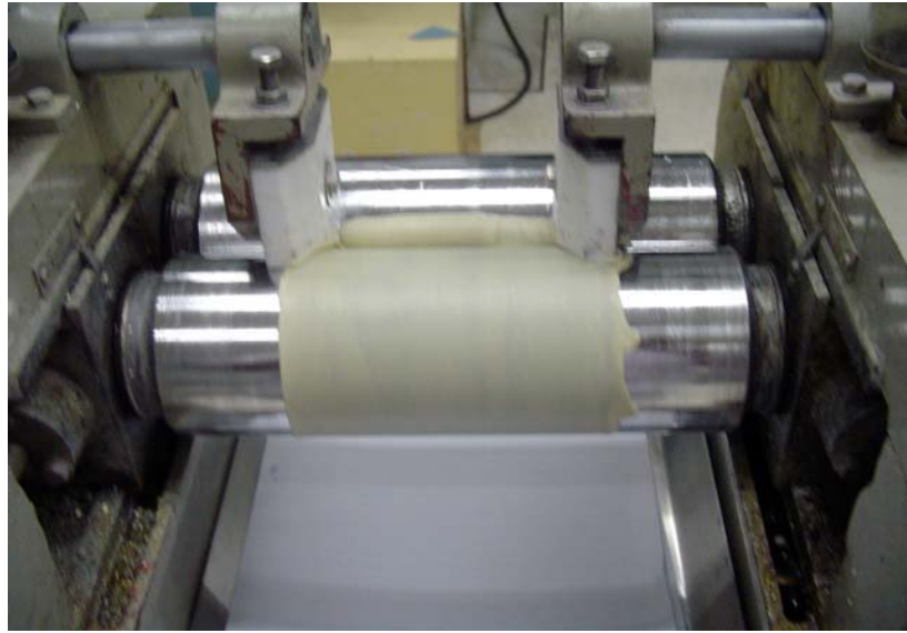
รูปที่ 3.4 การผสมยางกับสารเคมีด้วยเครื่องบดสองลูกกลิ้ง
