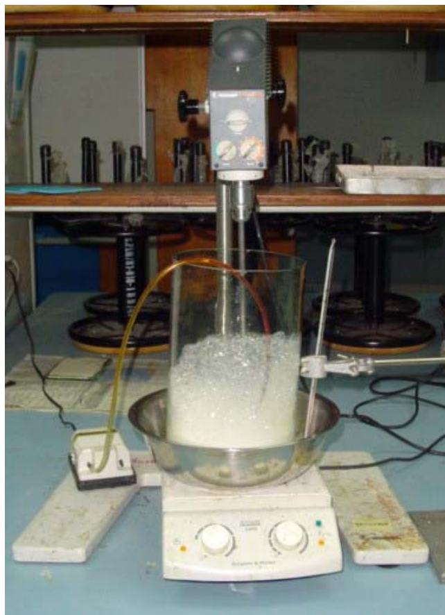
รูปที่ 3.8 การเตรียมน้ำยางเหลวจากน้ำยางข้น
