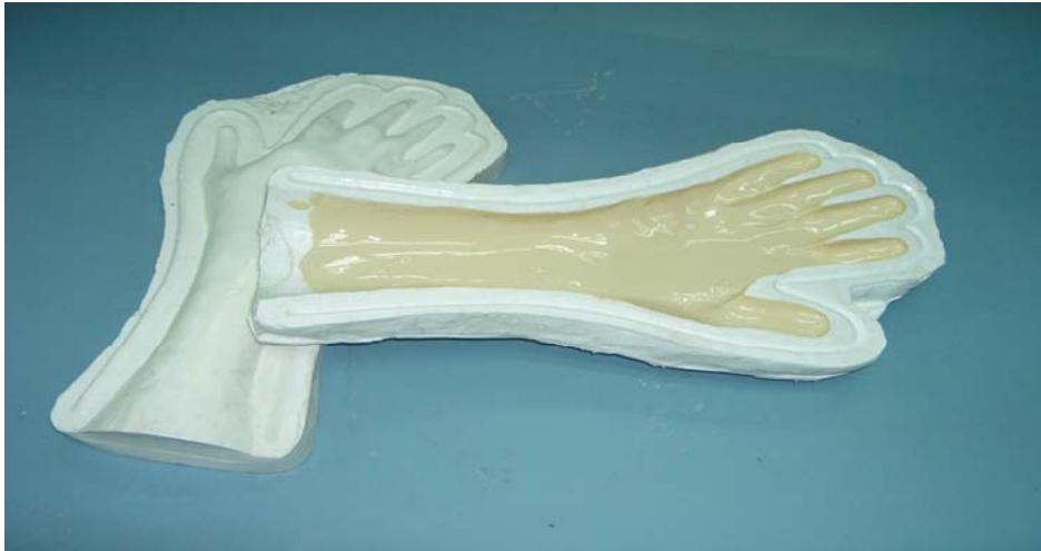
รูปที่ 3.16 แบบพิมพ์ผิวหนังแขนเทียมที่เทยางเหลวคอมปาวด์
