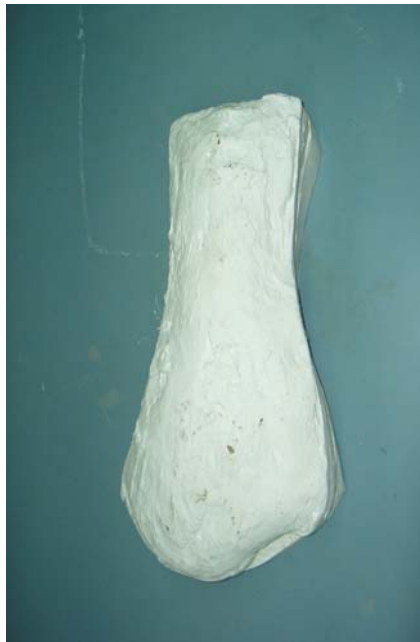
รูปที่ 3.17 แบบพิมพ์ผิวหนังแขนเทียมที่ใส่ยางคอมปาวด์ลงไปเพื่อนำไปอบวัลคาไนซ์
