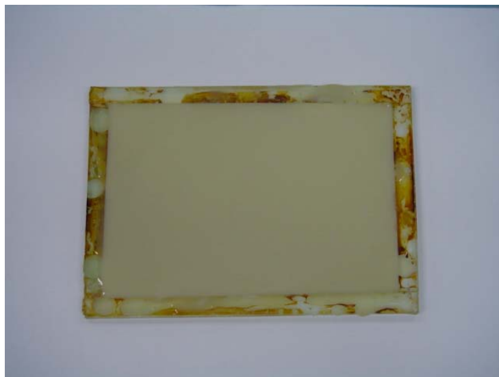
รูปที่ 3.7 การหล่อยางเหลวบนแผ่นกระຈก
