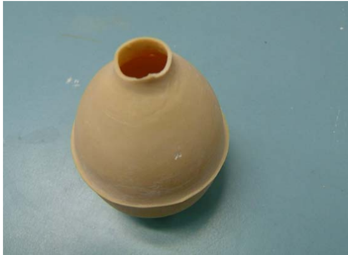
รูปที่ 9 ผลิตภัณฑ์ที่ได้จากการหล่อด้วยแป้งพลาสติก
