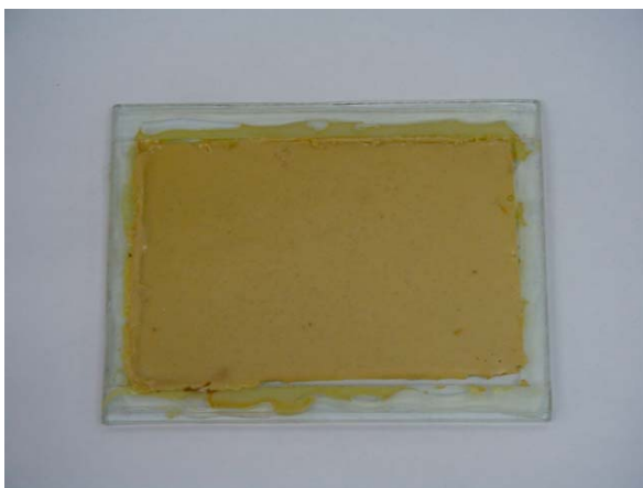
รูปที่ 2 ยางเหลวคอมปาวด์ที่เตรียมจากยางแท่งโดยใช้น้ำมันสปีนเดิล 200 phr และสารตัวเติม 75 phr หลังจากอบที่ 100°C 48 ชั่วโมง
