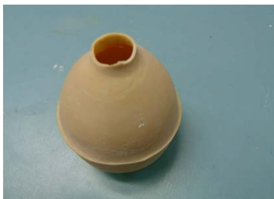
รูปที่ 4.55 ผลิตภัณฑ์ที่ได้จากการหล่อด้วยเบ้าปูนพลาสติก
