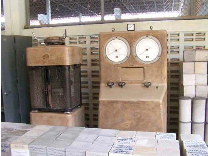
รูปที่ 2.4 เครื่องทดสอบความต้านต่อแรงกดของซีเมนต์และคอนกรีต
