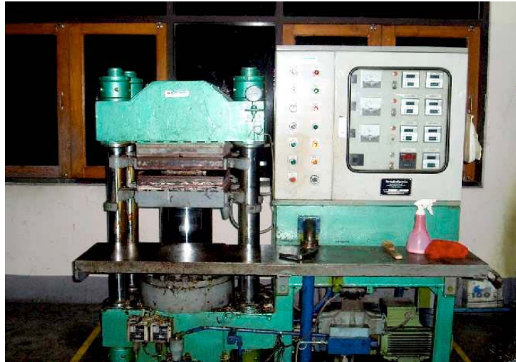
รูปที่ 2.5 เครื่องอัดเบ้าแบบไฮดรอลิก
