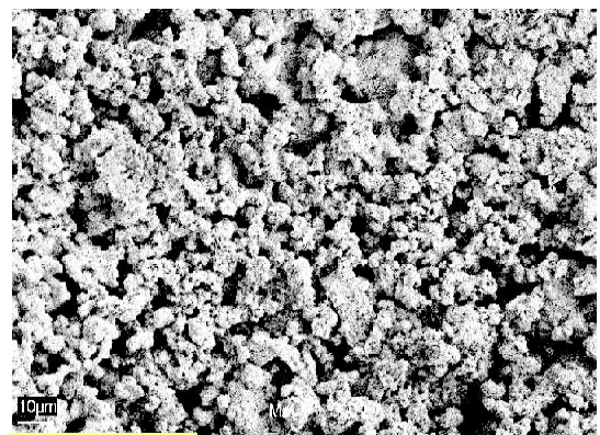
รูปที่ 4.7-4.8 ลักษณะทางสัณฐานวิทยาของพอลิเมอร์คอมโพสิตสูตรที่ไม่ใส่กากจีเป้ง
