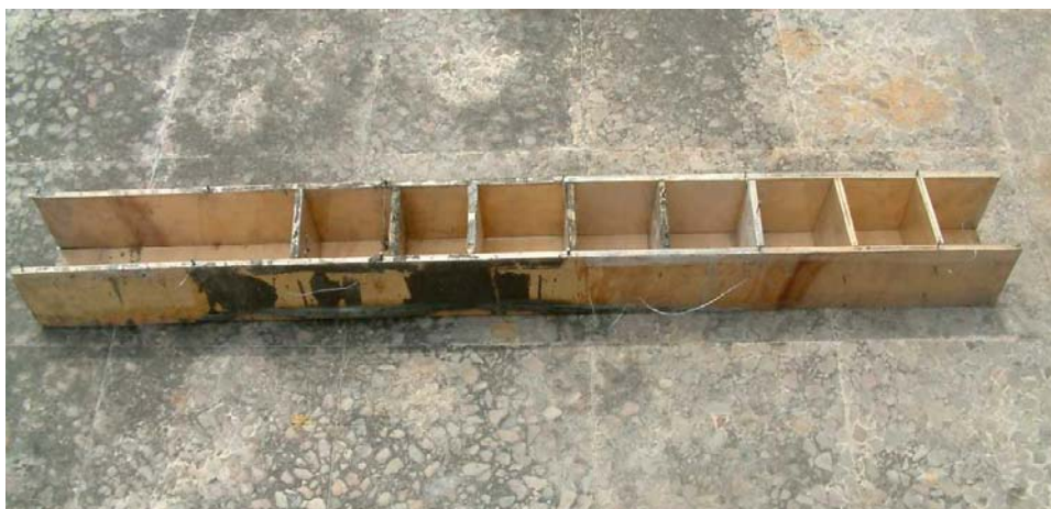
รูปที่ 2.1 เบ้าที่ใช้เตรียมพอลิเมอร์คอมโพสิตขนาด 10x10x10 ลูกบาศก์เซนติเมตร
