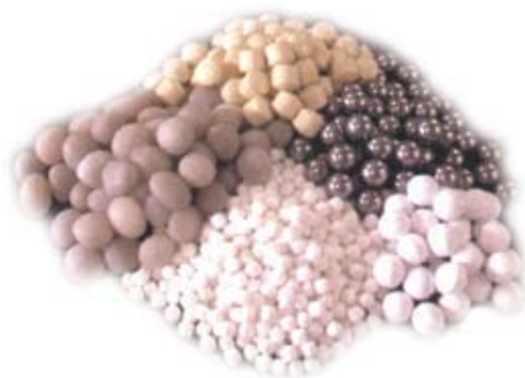
ภาพที่ 2 ขนาดของลูกบดขนาดต่าง ๆ เพื่อเพิ่มประสิทธิภาพในการบด
