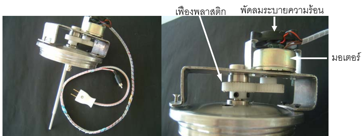
รูปที่ 28 ฝาปิดถังน้ำยาง ก.ชุดส่งกำลังให้กับใบกวน ข.เฟืองและมอเตอร์
