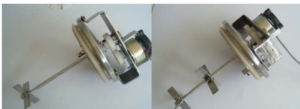
รูปที่ 28 ฝาปิดถังน้ำยาง ก.ชุดส่งกำลังให้กับใบกวน ข.เฟืองและมอเตอร์
