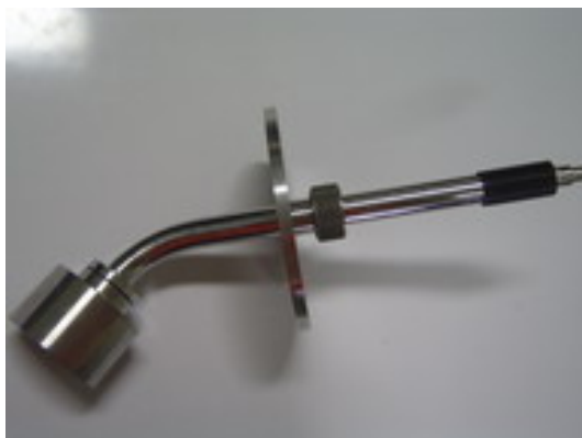
รูปที่ 4-10 ลักษณะของแมกนีตรอนคาโทดที่ประกอบเรียบร้อยแล้ว
