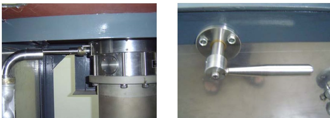
รูปที่ 4-4 วาล์วสุญญากาศสูงและระบบคานกระดกเพื่อเปิดปิดวาล์วของเครื่องเคลือบ
