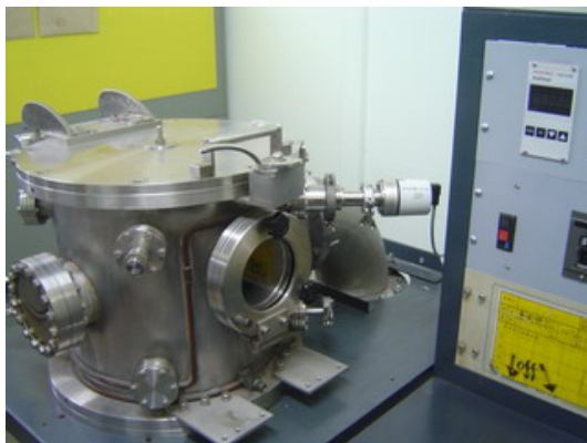
รูปที่ 4-7 มาตรวัดความดันแบบ full range พร้อมชุดแสดงผล
