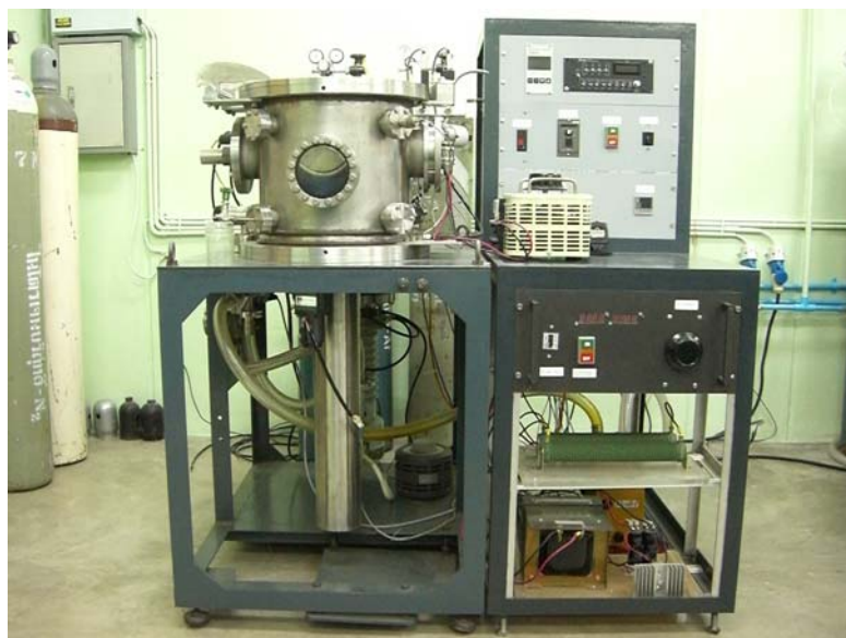
รูปที่ 4-1 เครื่องเคลือบในสุญญากาศระบบสปัตเตอริง ที่ใช้ในโครงการวิจัย
