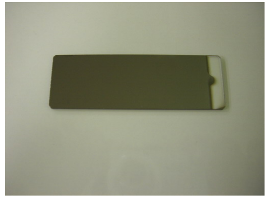
รูปที่ 4-18 ลักษณะของฟิล์มบางโครเมียมไนไตรด์ตัวอย่างที่เคลือบบนกระจกแผ่นเรียบ
