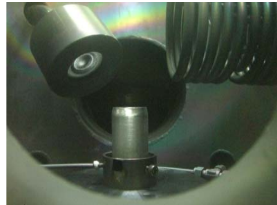
รูปที่ 4-25 ตำแหน่งและลักษณะการติดตั้งใบมีดยาวภายในเครื่องเคลือบ
