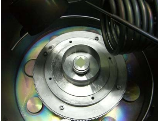
รูปที่ 4-24 ตำแหน่งและลักษณะการติดตั้งใบมีดสั้นภายในเครื่องเคลือบ
