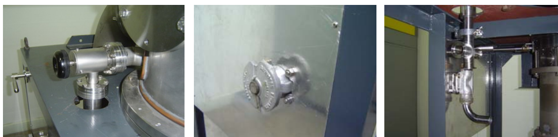
รูปที่ 4-5 วาล์ว roughing และ วาล์ว backing ของเครื่องเคลือบ
