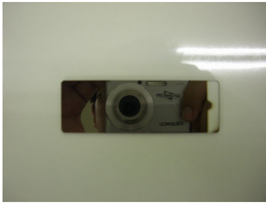
รูปที่ 4-18 ลักษณะของฟิล์มบางโครเมียมไนไตรด์ตัวอย่างที่เคลือบบนกระจกแผ่นเรียบ
