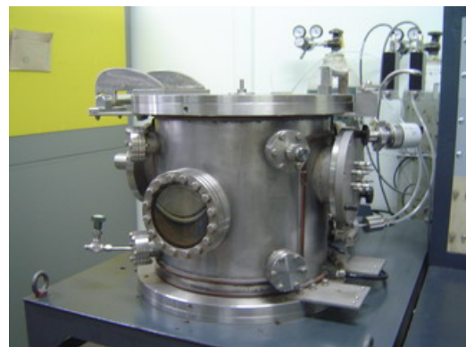
รูปที่ 4-2 ภาชนะสุญญากาศของเครื่องเคลือบในสุญญากาศที่ใช้ในโครงการ
