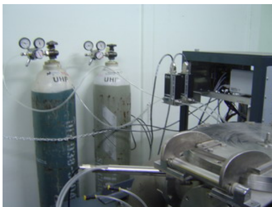
รูปที่ 4-6 ชุดควบคุมการปล่อยก๊าซอย่างละเอียดพร้อมทรานสดิวเซอร์
