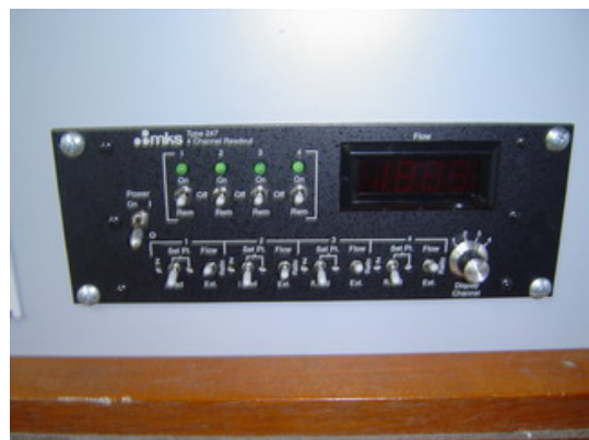
รูปที่ 4-6 ชุดควบคุมการปล่อยก๊าซอย่างละเอียดพร้อมทรานสดิวเซอร์
