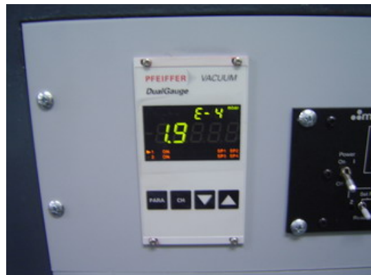
รูปที่ 4-7 มาตรวัดความดันแบบ full range พร้อมชุดแสดงผล
