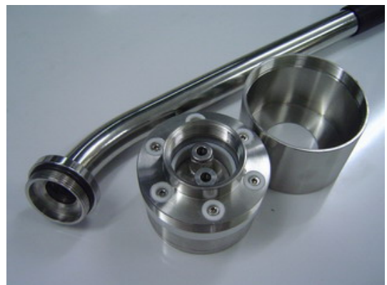
รูปที่ 4-10 ลักษณะของแมกนีตรอนคาโทดที่ประกอบเรียบร้อยแล้ว
