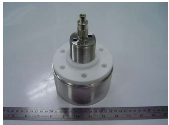
รูปที่ 4-9 ชิ้นส่วนของแมกนีตรอนคาโทดพร้อมส่วนประกอบที่สร้างขึ้นสำหรับเคลือบชิ้นงาน 3 มิติ
