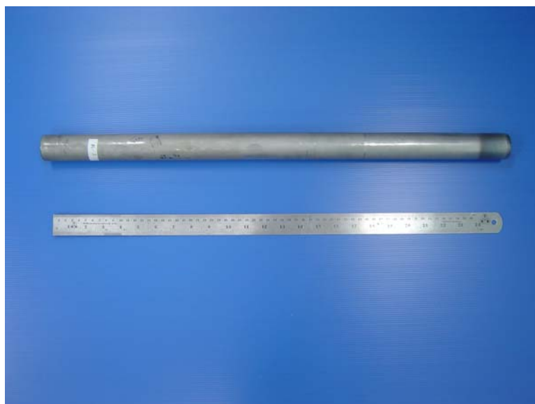
รูปที่ 3-2 ใบบิดตัดคว้านไส้สับปะรด ขนาดยาวสำหรับตัดไส้สับปะรด
