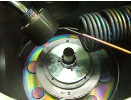
รูปที่ 4-25 ตำแหน่งและลักษณะการติดตั้งใบมีดยาวภายในเครื่องเคลือบ
