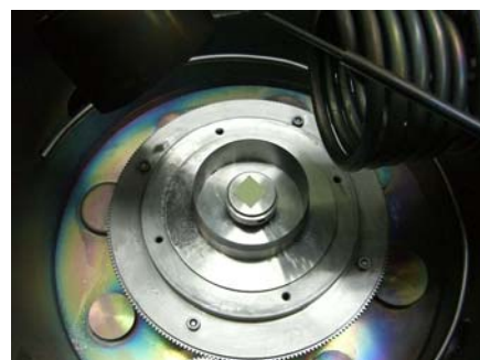
รูปที่ 4-8 ส่วนต่อขยาย ชุดจับชิ้นและชุดเกียร์ส่งกำลังสำหรับหมุนชิ้นงาน
