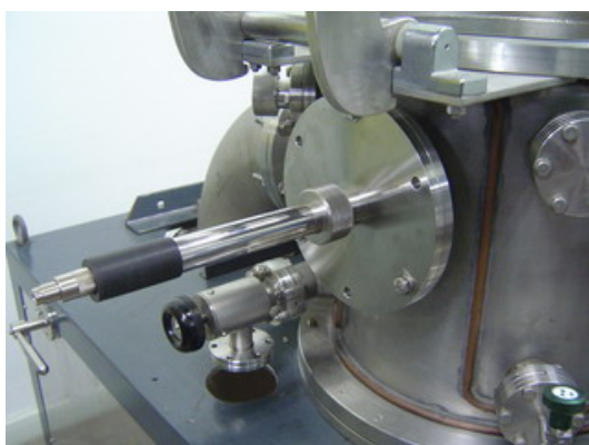
รูปที่ 4-11 การติดตั้งคาโทดกับพอร์ตด้านข้างของภาชนะสุญญากาศ และตำแหน่งคาโทดในภาชนะ
