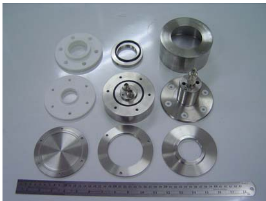
รูปที่ 4-9 ชิ้นส่วนของแมกนีตรอนคาโทดพร้อมส่วนประกอบที่สร้างขึ้นสำหรับเคลือบชิ้นงาน 3 มิติ
