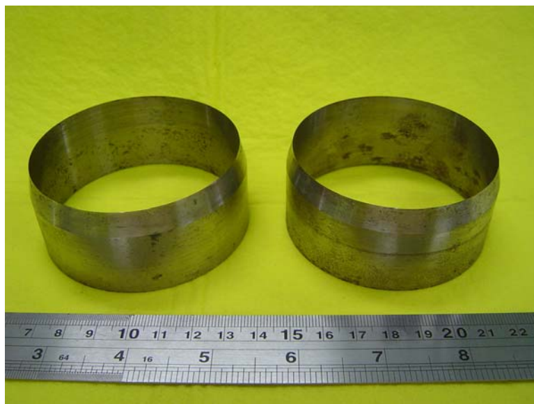
รูปที่ 3-1 ใบบิดตัดคว้านไส้สับปะรด ขนาดสั้นสำหรับตัดเปลือกสับปะรด
