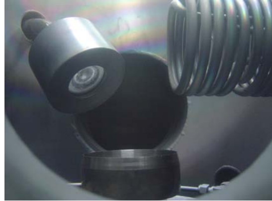
รูปที่ 4-24 ตำแหน่งและลักษณะการติดตั้งใบมีดสั้นภายในเครื่องเคลือบ
