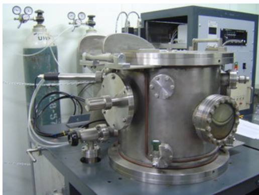
รูปที่ 4-2 ภาชนะสุญญากาศของเครื่องเคลือบในสุญญากาศที่ใช้ในโครงการ
