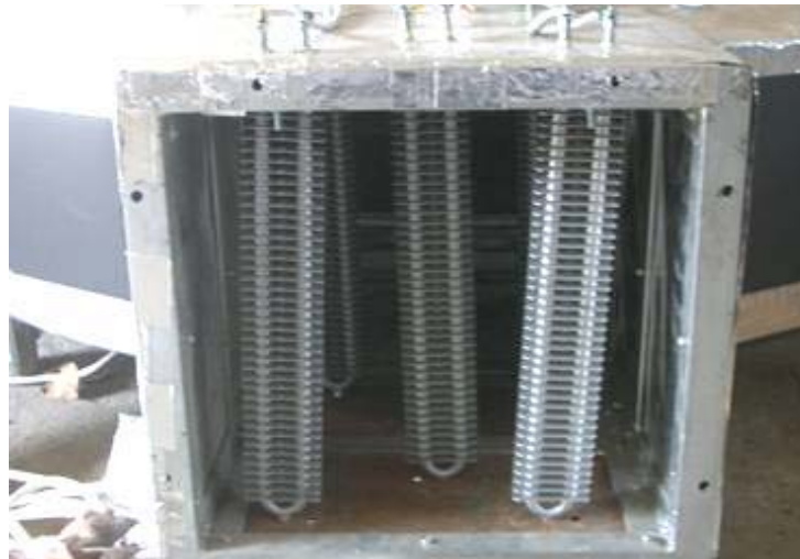
รูปที่ 3.6 ฮีตเตอร์แบบสแตนเลส ขนาด 600 W
