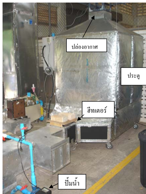
รูปที่ 3.4 ตู้อบแห้งยางแผ่นดิบ (ด้านประตูตู้อบ)
