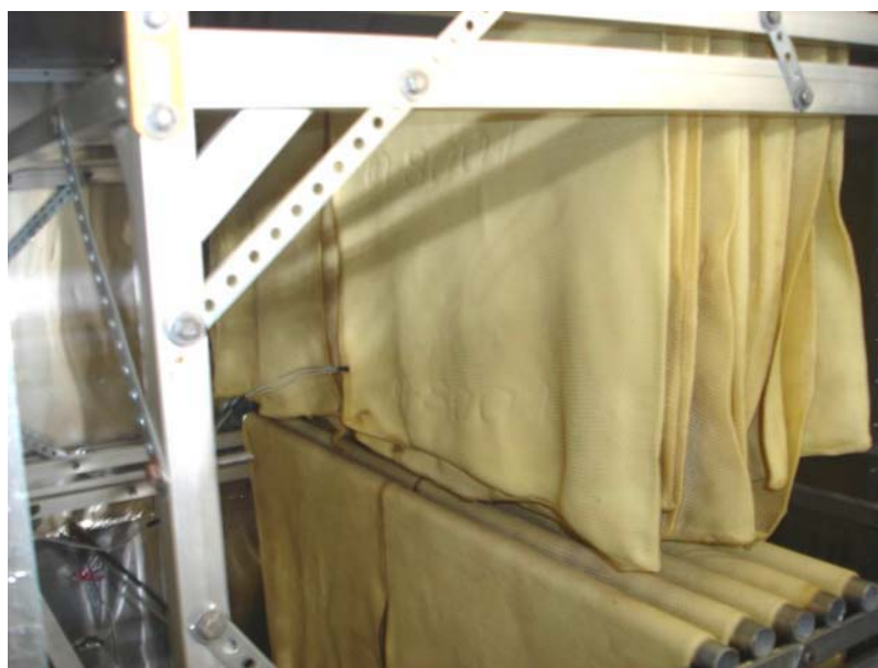
รูปที่ 3.24 แสดงลักษณะการแขวนยางแห้งแผ่นดิบบนราวตากในตู้อบทดสอบ
