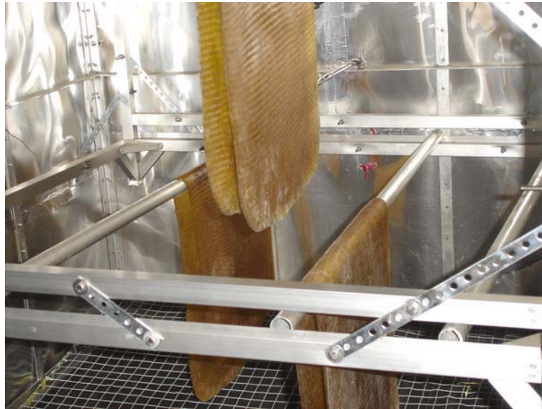
รูปที่ 3.7 ราวแขวนยางแผ่นดิบในตู้อบที่สามารถปรับระยะห่างของยางแผ่นได้
