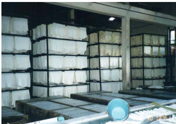
รูปที่ 3.37 การผึ่งยางในร่มโดยแขวนกับราวไม้ไผ่บนกระเบยโครงเหล็กภายในโรงเรือนรีดยางแผ่นของสหกรณ์สวนยางพารา
