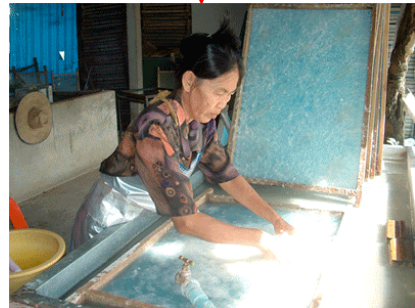
7. นำเยื่อมาตะແ່ນบนเฟรมในรางน้ำ
