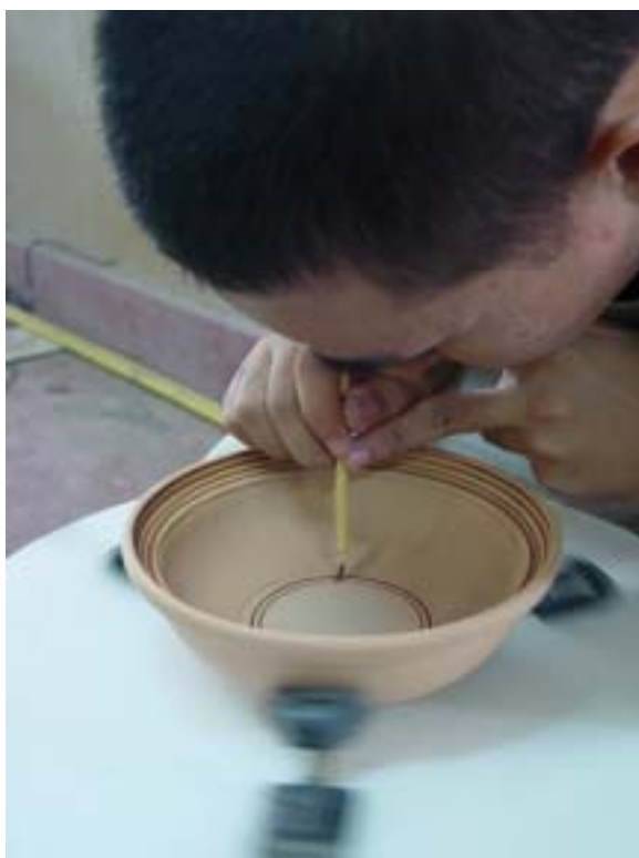
ภาพที่ 89 แสดงการวงเส้นวงกลมบนเป็นหมุน
