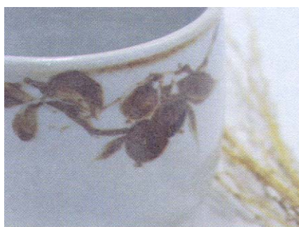
ภาพที่ 53 แสดงผลการทดสอบการใช้เหล็กออกไซด์เขียนใต้เคลือบสี (กาญจนา อินทรชิต 2545 : 25)
