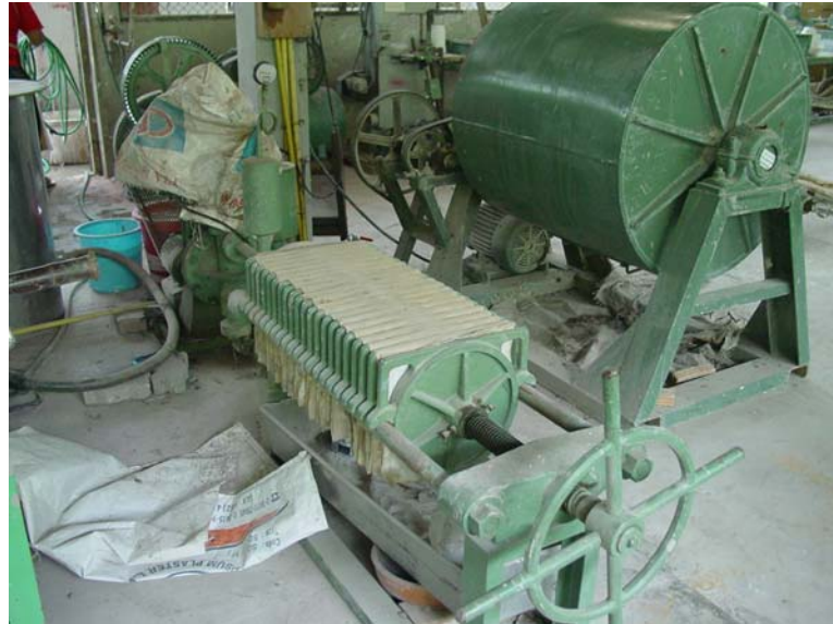
ภาพที่ 80 แสดงการป้อนน้ำดินเข้าเครื่องรีดน้ำดิน (Filter-Press)
