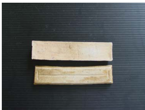
ภาพที่ 66 แสดงผลการวิเคราะห์คุณสมบัติการหดตัวและสีของเนื้อดินชั้นละเอียดหลังเผา
