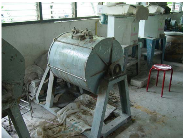
ภาพที่ 79 แสดงการปั่นส่วนผสมของดินในหม้อบด (Plug Mill)
