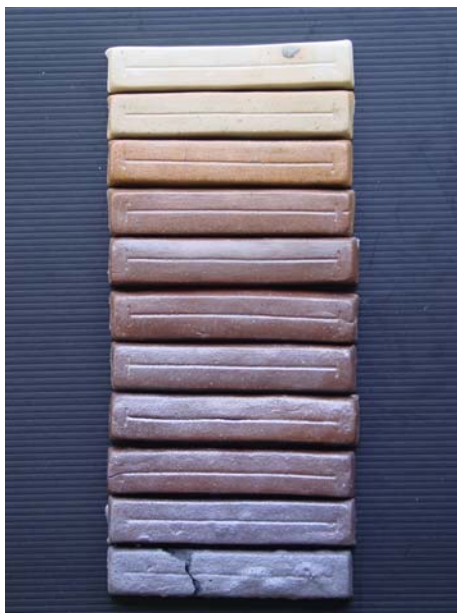
ภาพที่ 64 แสดงผลการวิเคราะห์คุณสมบัติการหดตัวและสีของเนื้อดินหลังเผา
