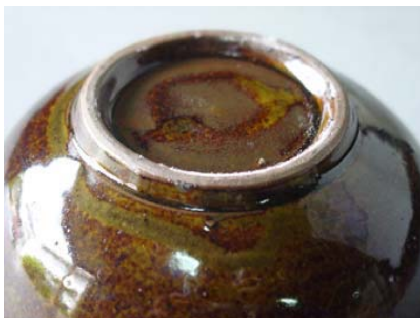
ภาพที่ 101 แสดงผลิตภัณฑ์ที่มีเคลือบบางจากการทดลองผลิตครั้งที่ 2
