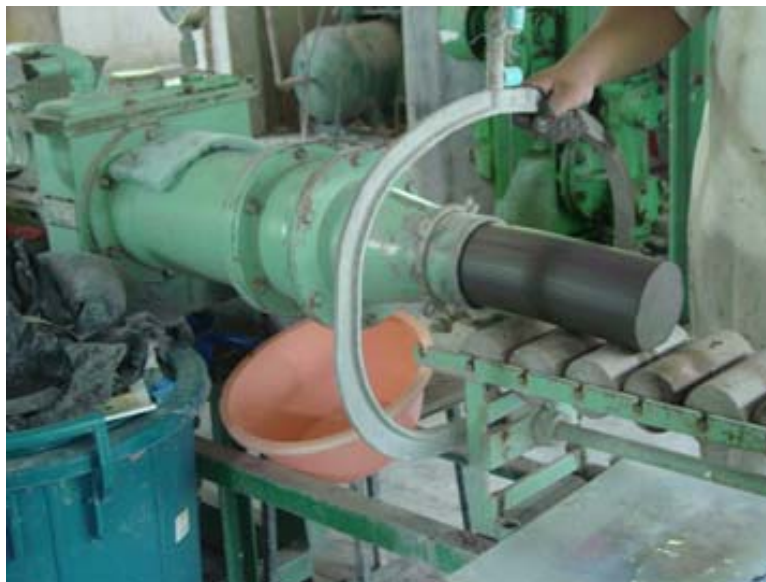
ภาพที่ 81 การอัดดินเพื่อไล่ฟองอากาศในเครื่องนวดดิน (Extruder)
