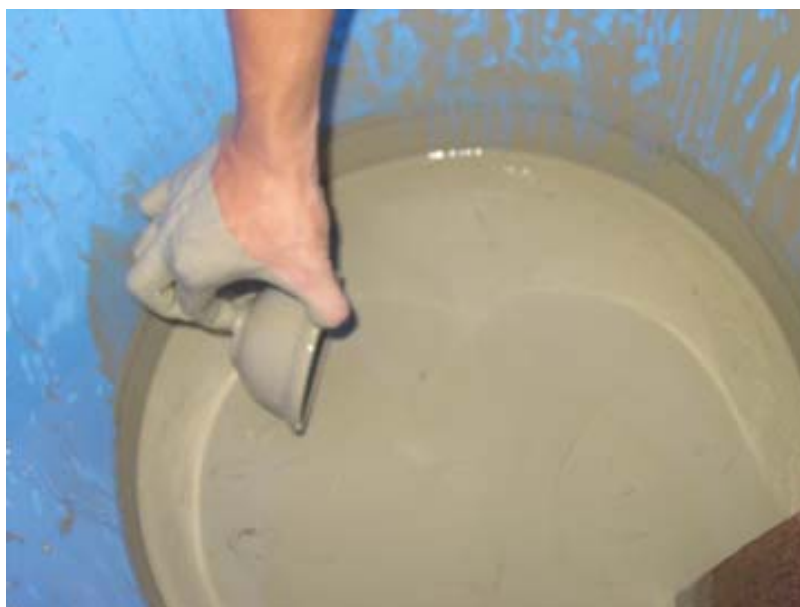
ภาพที่ 93 แสดงการชุบเคลือบแบบจุ่ม
