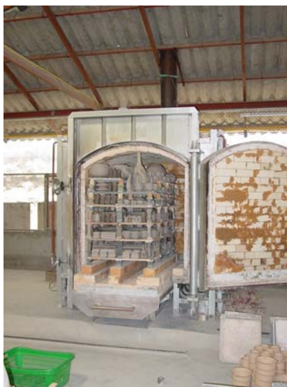
ภาพที่ 61 แสดงเตาเผาแบบไม่ต่อเนื่อง (Shuttle Kiln) เชื้อเพลิงแก๊ส ที่ใช้ในการเผาดิบและเผาเคลือบผลิตภัณฑ์ของโรงงานบ้านศิลาดล
