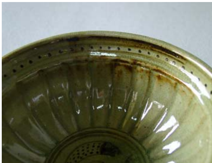
ภาพที่ 98 แสดงผลิตภัณฑ์ที่เคลือบบางจากการทดลองผลิตครั้งที่ 1
