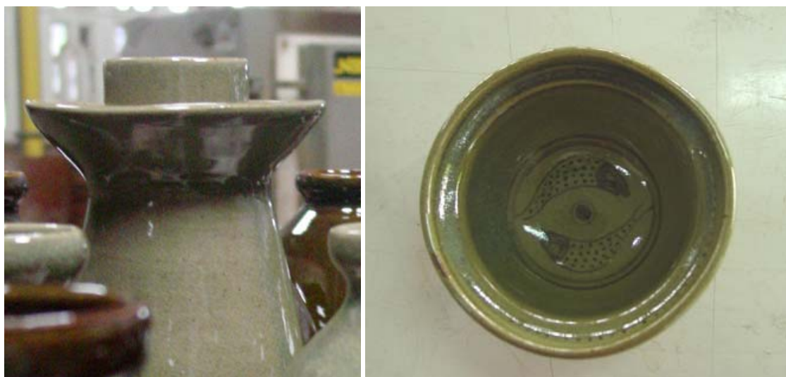
ภาพที่ 103 แสดงผลิตภัณฑ์ที่บิดเบี้ยวโดยเฉพาะบริเวณปากภาชนะจากการทดลองผลิตครั้งที่ 3
