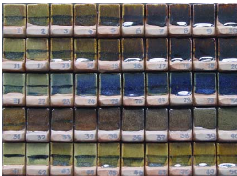
ภาพที่ 70 แสดงผลการทดลองการปรับปรุงสีเคลือบ
