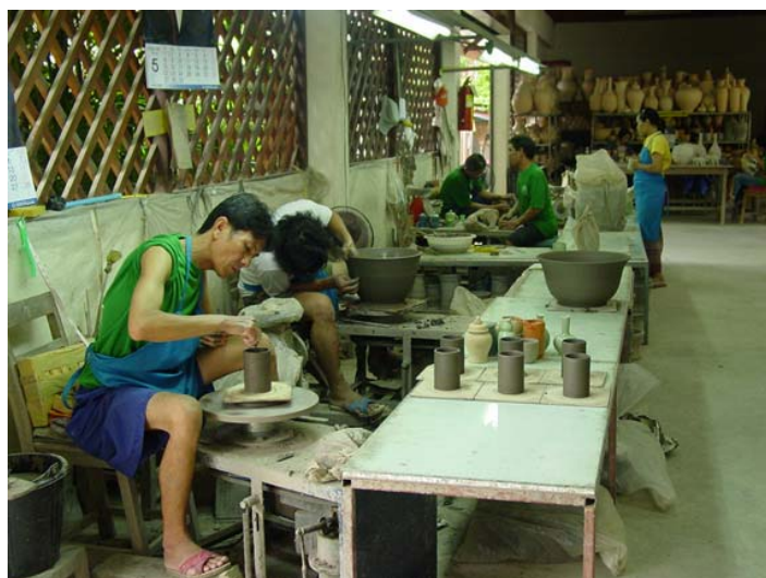
ภาพที่ 56 แสดงการขึ้นรูปด้วยแป้นหมุนของโรงงานบ้านศิลาดล
