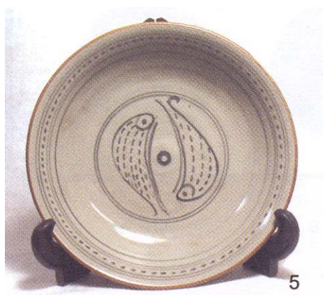
ภาพที่ 54 แสดงผลการทดสอบการใช้ดินแดงคอยสะกัด 9 ส่วนต่อสีสำเร็จรูป 1 ส่วน เขียนใต้เคลือบจีเถ้าไม้ก้อย (กาญจนา ดิบบาง 2546 : 48)
