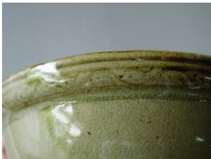
ภาพที่ 99 แสดงผลิตภัณฑ์ที่เขียนสีได้เคลือบบางทำให้ซีดจางจากการทดลองผลิตครั้งที่ 1
