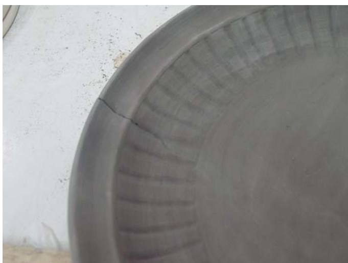
ภาพที่ 86 แสดงผลิตภัณฑ์ที่แตกร้าวเนื่องจากการปล่อยให้แห้งเร็ว
