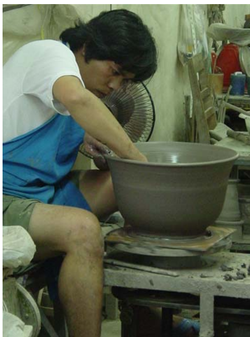
ภาพที่ 82 แสดงการขึ้นรูปผลิตภัณฑ์ด้วยแป้นหมุน
