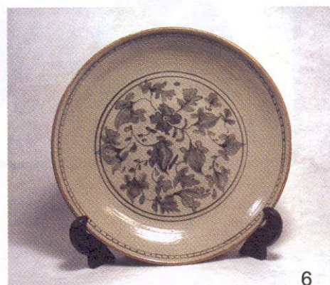
ภาพที่ 54 แสดงผลการทดสอบการใช้ดินแดงคอยสะกัด 9 ส่วนต่อสีสำเร็จรูป 1 ส่วน เขียนใต้เคลือบจีเถ้าไม้ก้อย (กาญจนา ดิบบาง 2546 : 48)
