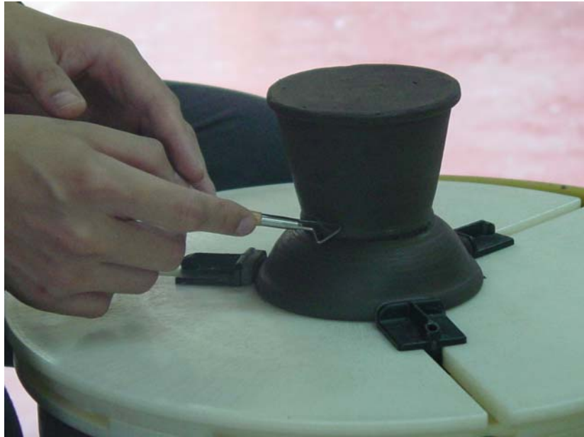
ภาพที่ 83 แสดงการเหลาแต่งรูปทรงภายนอก
