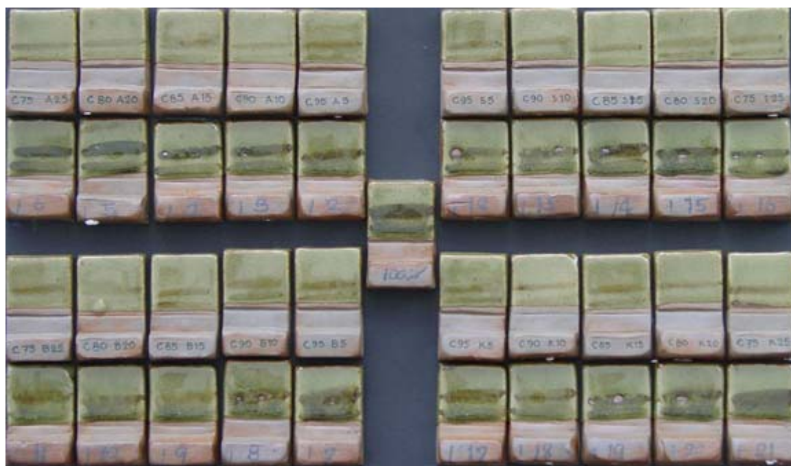
ภาพที่ 72 แสดงผลการทดลองความคมชัดของสีตกแต่งได้เคลือบสีลาด
