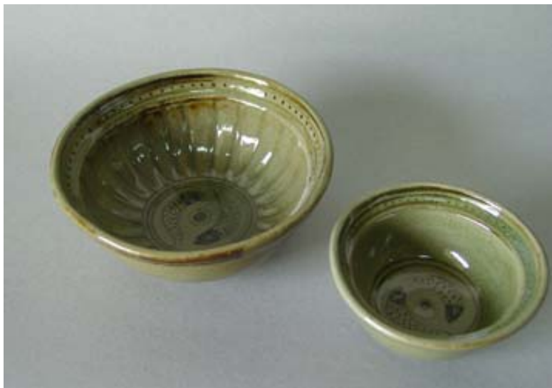
ภาพที่ 97 แสดงผลิตภัณฑ์ที่เปื้อยบริเวณปากภาชนะจากการทดลองผลิตครั้งที่ 1
