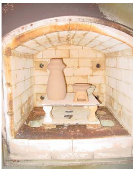
ภาพที่ 94 แสดงการบรรจุผลิตภัณฑ์ที่ชุบเคลือบแล้วเข้าเตาเผาเพื่อเผาเคลือบ
