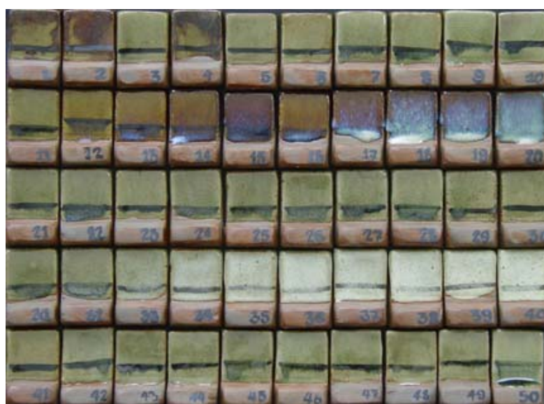
ภาพที่ 69 แสดงผลการทดลองการปรับปรุงความใสและทึบในเคลือบ
