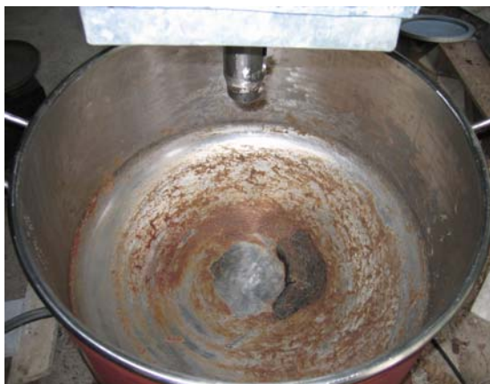
ภาพที่ 4.3 การไหม้จากใบกวนแบบแรงคู่ควบกวนกล้วย 10 kg
