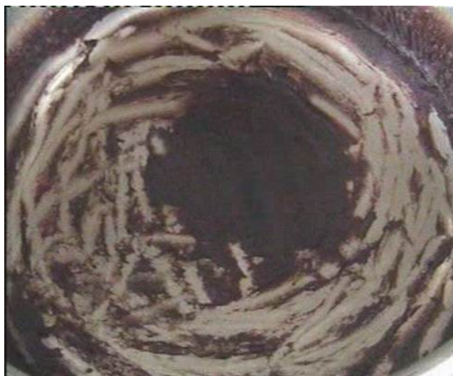
ภาพที่ 4.6 การไหม้จากใบกวนแบบแรงคู่ควบกวนกล้วย 30 kg
