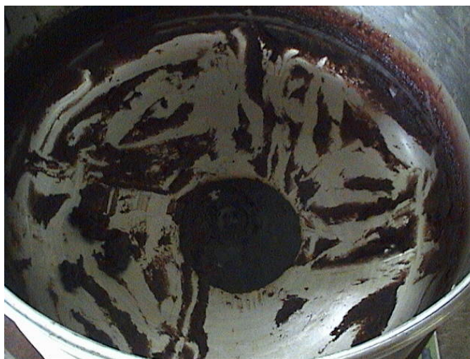
ภาพที่ 4.5 การไหม้จากใบกวนแบบคายนกเฉพาะกวนกล้วย 30 kg
