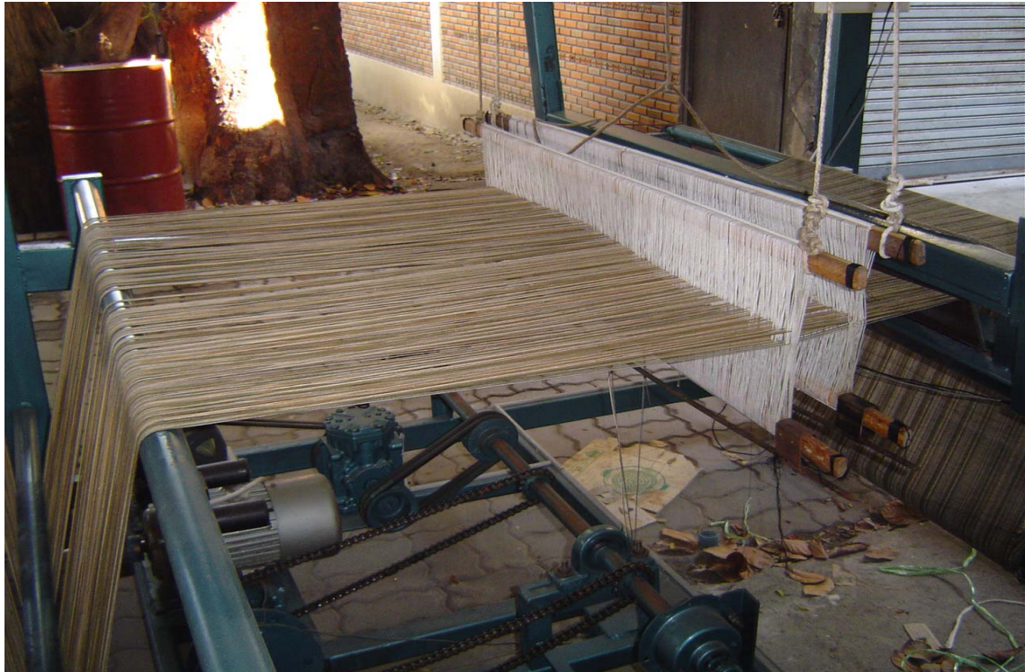
รูป ง - 7 แสดงภาพการต่อค้าก่อนทำการทอผ้า
