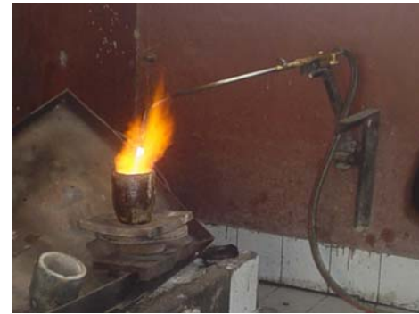
ภาพที่ 59-60 ให้ความร้อนโดยการใช้แก๊ส
