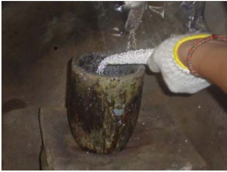
ภาพที่ 57-58 เทโลหะลงในเบ้าหลอม
