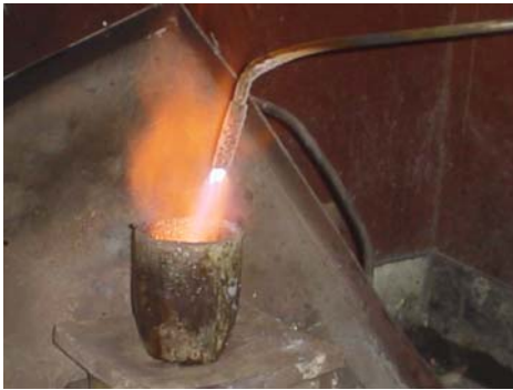
ภาพที่ 59-60 ให้ความร้อนโดยการใช้แก๊ส
