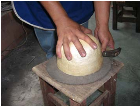
ภาพที่ 105-106 เก็บรายละเอียดของปากชิ้นให้เรียบโดยการเคาะ
