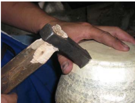
ภาพที่ 101-102 การตีลบมุมส่วนก้นของชิ้น
