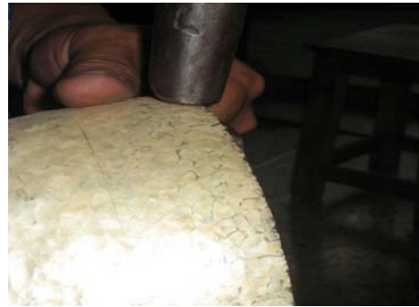
ภาพที่ 105-106 เก็บรายละเอียดของปากชิ้นให้เรียบโดยการเคาะ
