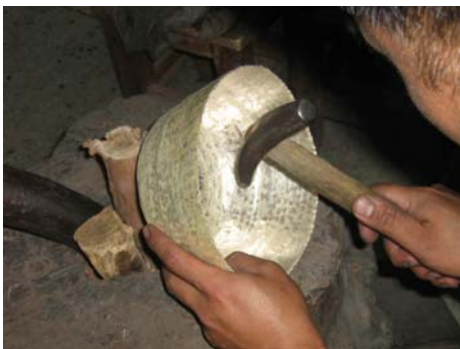
ภาพที่ 103-104 แต่งรูปทรงของชิ้นให้สมส่วน
