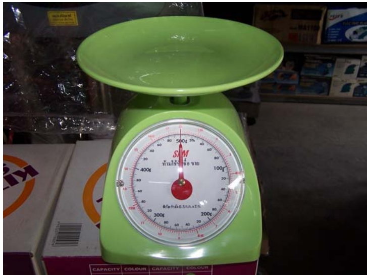
รูปที่ 4.1 เครื่องชั่ง ความละเอียด 0.005 กิโลกรัม
