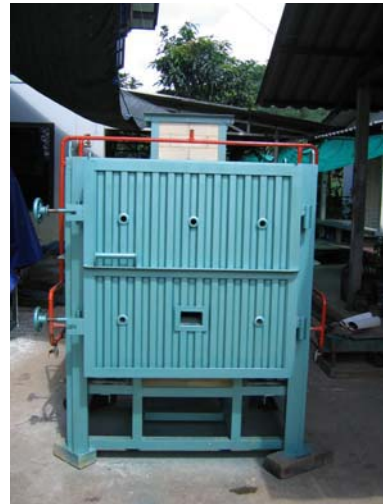
ภาพที่ 9 เตาเผาแบบใช้แก๊สสำหรับการเผาและการอบแห้งขึ้นทดสอบ
