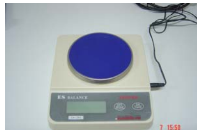
ภาพที่ 10 เครื่องชั่งไฟฟ้าสำหรับการชั่งน้ำหนักดินเพื่อคำนวณหาปริมาณความชื้น
