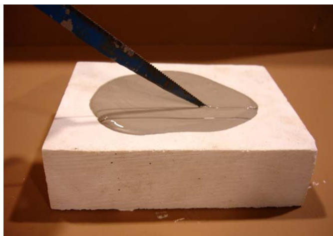
ภาพที่ 5.2 แผ่นปูนปลาสเตอร์ สำหรับหาปริมาณน้ำสูงสุดที่ทำให้เนื้อดินเกิดสภาพพลาสติก
