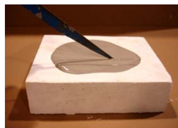
ภาพที่ 6 แผ่นปูนปลาสเตอร์ สำหรับหาปริมาณน้ำสูงสุดที่ทำให้เนื้อดินเกิดสภาพพลาสติก
