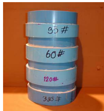
ภาพที่ 5 ชุดตะแกรงร่อนสำหรับหาปริมาณกากค่างตะแกรง
