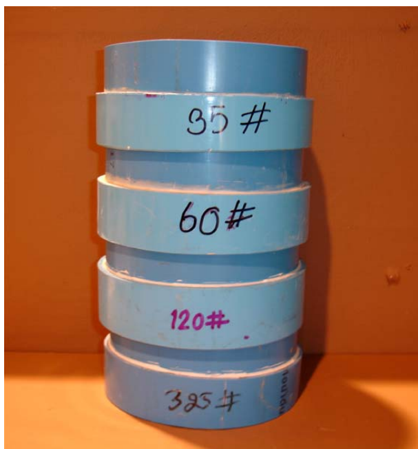
ภาพที่ 5.1 ชุดตะแกรงร่อนสำหรับหาปริมาณกากค้ำตะแกรง
