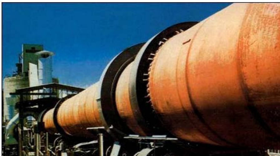
รูปที่ 2.2 ภาพของโรตารีคิลน์ใช้ในกระบวนการผลิตซีเมนต์
