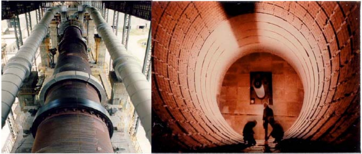
รูปที่ 2.3 ลักษณะภายนอกและภายในของเตาเผาซีเมนต์ (Rotary kiln)
