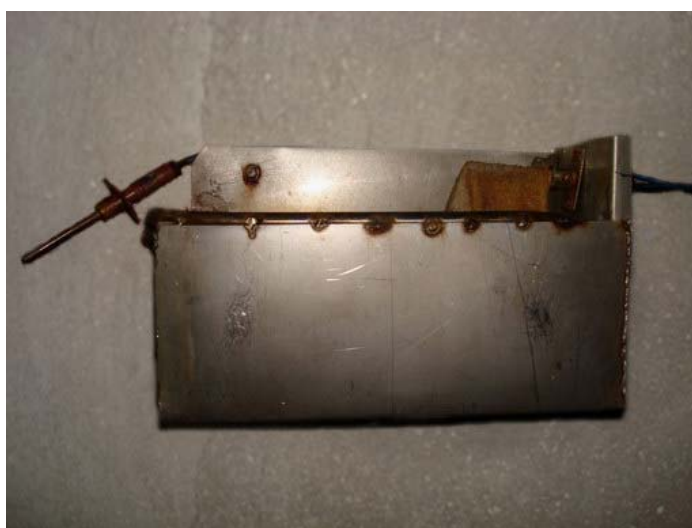
ภาพที่ 7.2 อุปกรณ์วัดอุณหภูมิกระเปาะแห้งและกระเปาะเปียกเป็นเทอร์โมคัปเปิลขนาด
