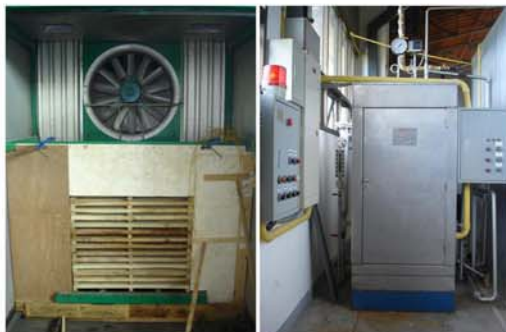
รูปที่ 1 เตาอบไม้ยางพาราแสดงการจัดไม้สำหรับการทดลอง (ซ้าย) และเครื่องกำเนิดไอน้ำด้วยไฟฟ้า (ขวา)
