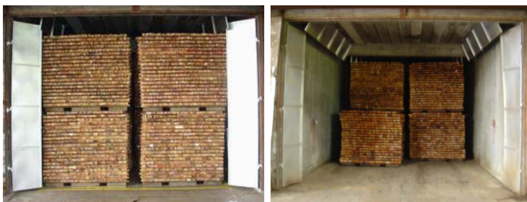
ภาพที่ 7.7 แสดงการติดตั้งแผ่นกั้นลมด้านหน้าและด้านหลัง
