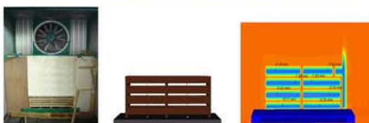
วัดค่าอัตราเร็วลมจากเตาอบในห้องปฏิบัติการและผลการจำลองด้วยคอมพิวเตอร์
