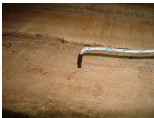
ภาพที่ 7.10 การติดตั้งหัววัดอุณหภูมิไม้
