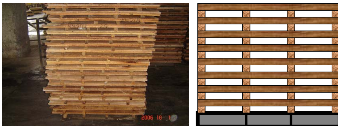
ภาพที่ 7.6 แสดงการเรียงไม้ของโรงงานกับการเรียงไม้ที่ถูกต้อง
