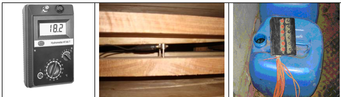
ภาพที่ 7.9 เครื่องวัดความชื้นไม้ การติดตั้งหัววัดความชื้นไม้และจุดวัดความชื้นไม้นอกเตา
