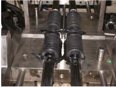
รูปที่ 11 ชิ้นงานยางรองที่วางแท่งจักรยานยนต์ที่ได้หลังจากการขึ้นรูปโดยการฉีด
