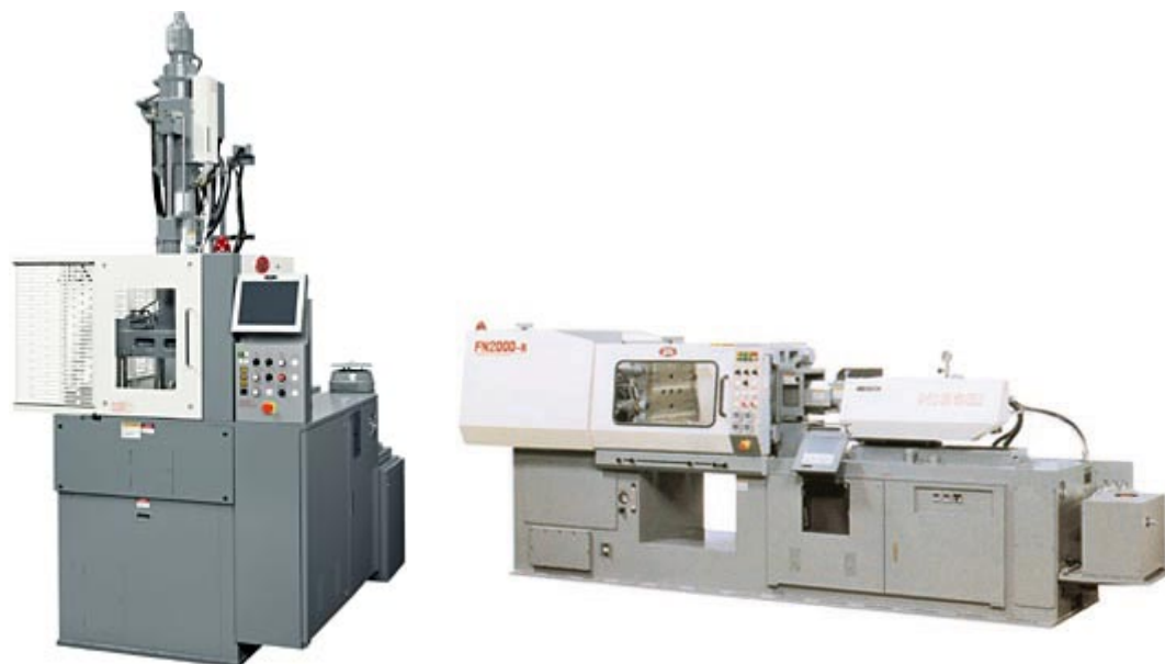
รูปที่ 23 เครื่องฉีดยางแบบแนวตั้ง (Vertical Injection Machine) และแบบแนวนอน (Horizontal Injection Machine) [29]
