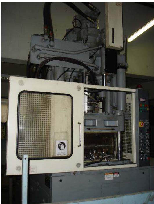
รูปที่ 82 เครื่องอัดยางแนวตั้ง ขนาด 100 ตัน
