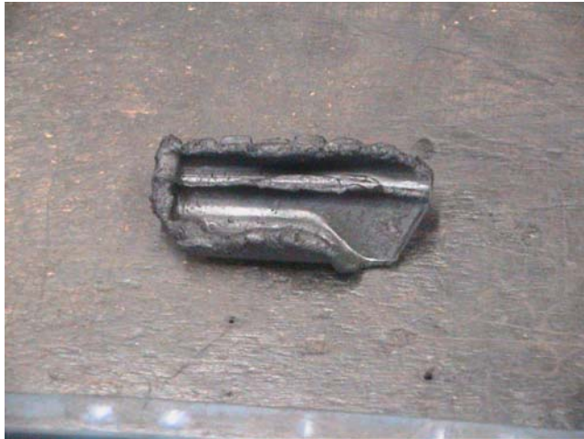
รูปที่ ง-2 ลักษณะของเสียที่เกิดขึ้นกับชิ้นงานจากการฉีดยางไม่เต็มแม่พิมพ์
