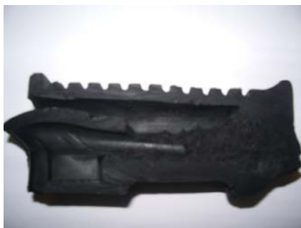
รูปที่ 16 ภายในของชิ้นงานที่เนื้อยางไม่สุกบริเวณที่ติดกับตัว
