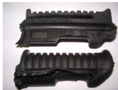
รูปที่ 18 ภายในของชิ้นงานที่เนื้อยางสุกทั่วถึงกัน
