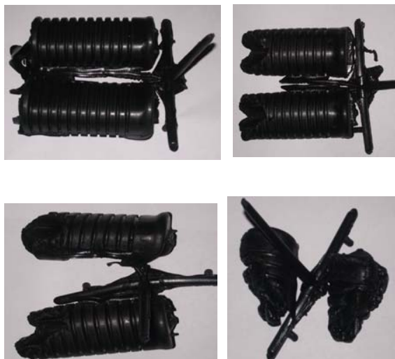
รูปที่ 12 ชิ้นงานที่อัตราส่วนการฉีด 80% 60% 40% และ 20% ตามลำดับ
