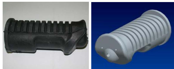
รูปที่ 1 ยางที่วางเท้าที่ใช้ในการเหยียบเบรกในรถจักรยานยนต์
