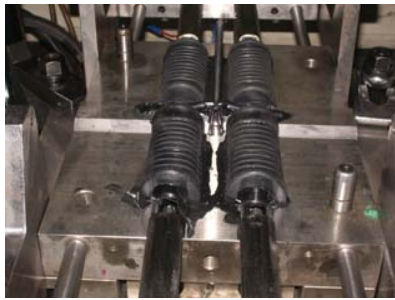
รูปที่ 11 ชิ้นงานยางรองที่วางแท่งจักษ์ยานยนต์ที่ได้หลังจากการขึ้นรูปโดยการฉีด
