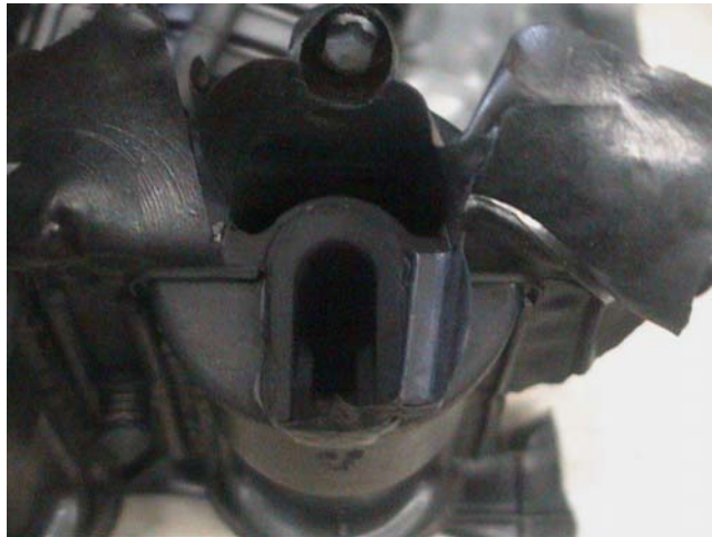
รูปที่ ง-1 ลักษณะของเสียที่เกิดขึ้นกับชิ้นงาน โดยเกิดการขาดของชิ้นงานที่บริเวณ
