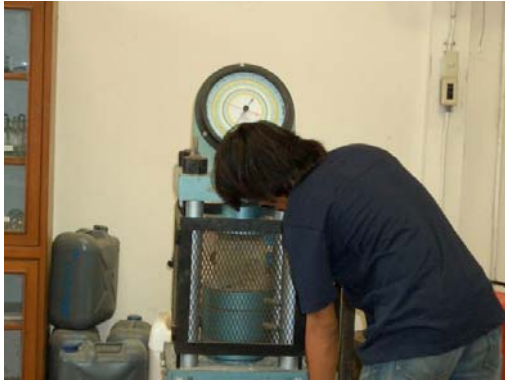
รูปที่ 3.9 การทดสอบกำลังอัดประลัยของก้อนคอนกรีตตัวอย่าง
