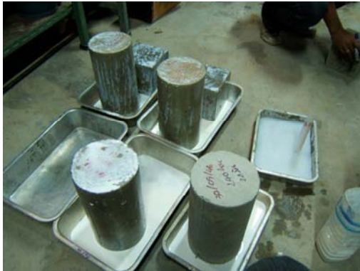
รูปที่ 3.3 การทาเคลือบน้ำยาพารากับตัวอย่างคอนกรีต
