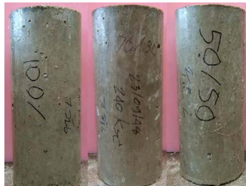
รูปที่ 3.8 รูปแบบการบ่มโดยการเคลือบน้ำยาอัตราส่วนต่างๆ
