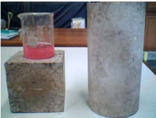
รูปที่ 3.7 รูปแบบการบ่มโดยการใช้ยาเคมีเคลือบ
