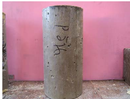
รูปที่ 3.6 รูปแบบการบ่มโดยการเคลือบน้ำยาฟริวคาลินด์
