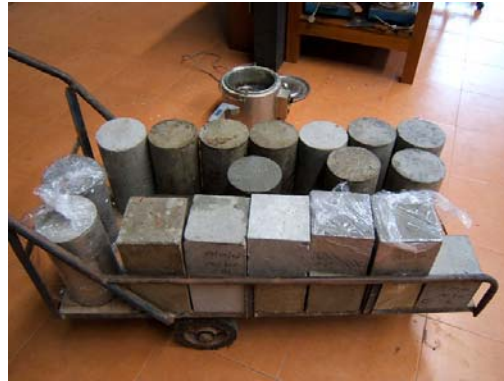
รูปที่ 3.4 ตัวอย่างคอนกรีตเตรียมทดสอบกำลังอัด
