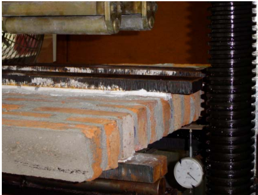
(ข) การรองรับที่ปลาย และการติดตั้งแผ่นเหล็กเพื่อการถ่ายแรงกระทำ
