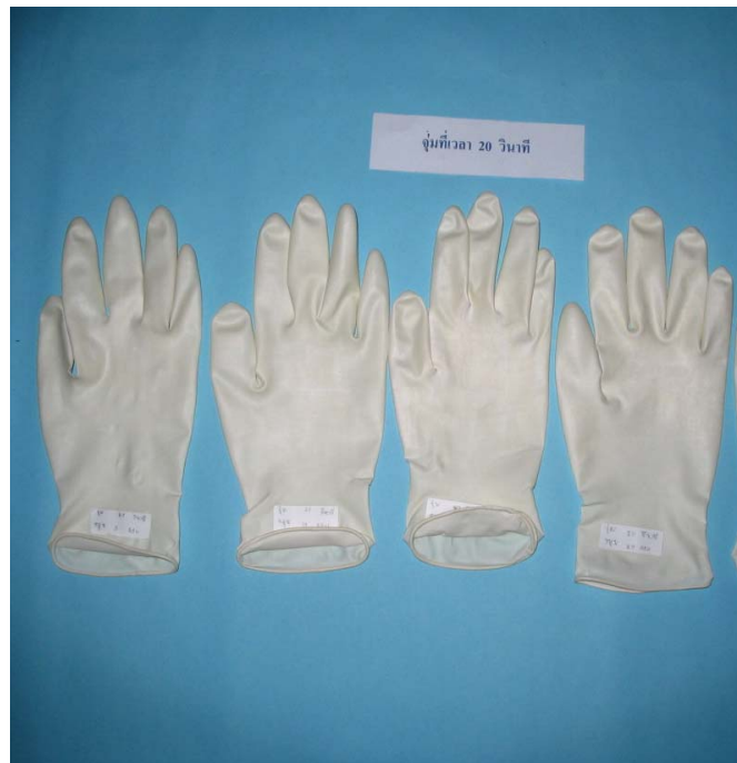
ภาพที่ ข.15 การจุ่มโดยใช้เครื่องจุ่มถุงมือยางพาราแบบกึ่งอัตโนมัติโดยใช้สารจับตัวจุ่มที่เวลา 20 วินาที
