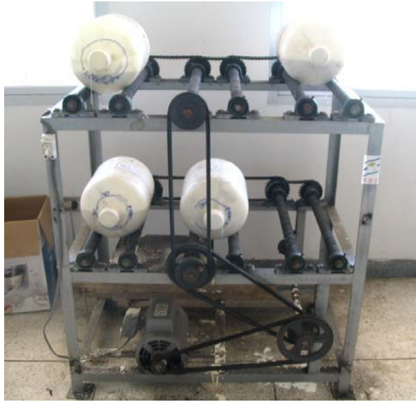
ภาพที่ ค.10 เครื่องบอลมิลสำหรับเตรียมสารเคมีและยางพารา
