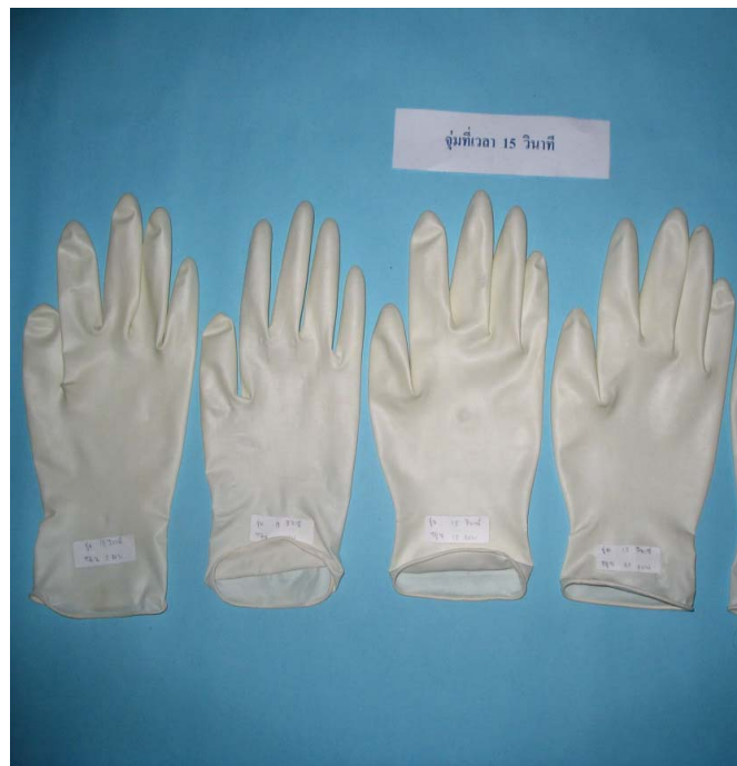
ภาพที่ ข.13 การจุ่มโดยใช้เครื่องจุ่มถุงมือยางพาราแบบกึ่งอัตโนมัติโดยใช้สารจับตัวจุ่มที่เวลา 15 วินาที
