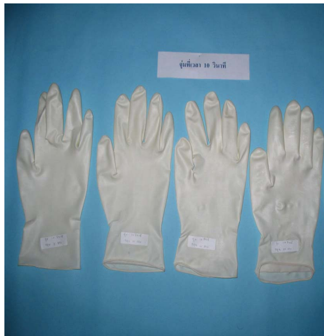
ภาพที่ ข.11 การจุ่มโดยใช้เครื่องจุ่มถุงมือยางพาราแบบกึ่งอัตโนมัติโดยใช้สารจับตัวจุ่มที่เวลา 10 วินาที
