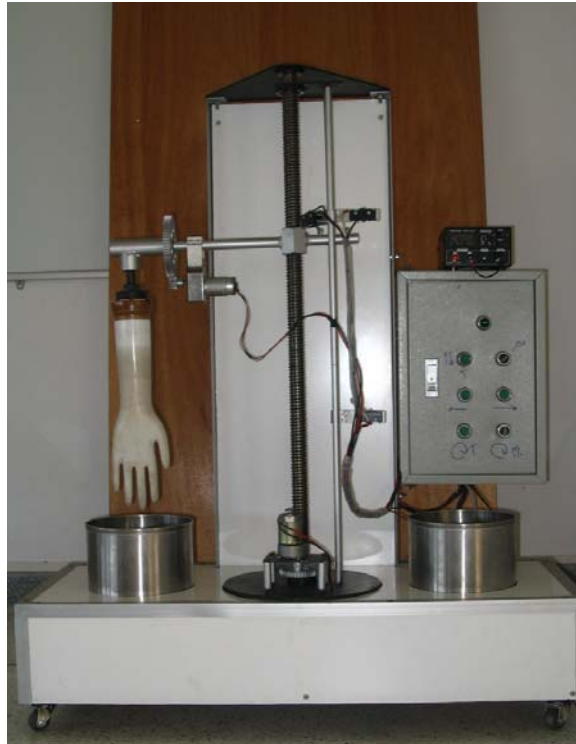
ภาพที่ 4.1 เครื่องจุ่มถุงมือยางพาราแบบกึ่งอัตโนมัติโดยใช้สารจับตัว
