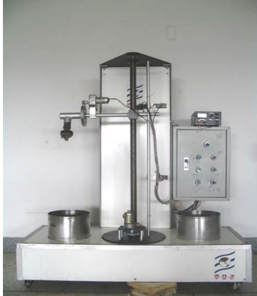
ภาพที่ ค.6 เครื่องจุ่มถุงมือยางพาราแบบกึ่งอัตโนมัติโดยใช้สารช่วยจับตัว
