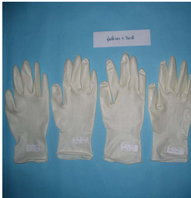
ภาพที่ ข.9 การจุ่มโดยใช้เครื่องจุ่มถุงมืออย่างพาราแบบกึ่งอัตโนมัติโดยใช้สารจับตัวจุ่มที่เวลา 5 วินาที
