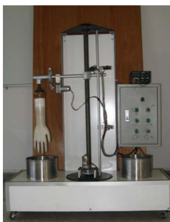
ภาพที่ 3 เครื่องจุ่มถุงมือยางพาราแบบกึ่งอัตโนมัติโดย ใช้สารจับตัว
