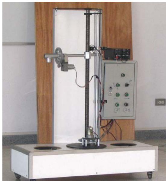
ภาพที่ ค.7 เครื่องจุ่มถุงมือยางพาราแบบกึ่งอัตโนมัติโดยใช้สารช่วยจับตัวที่ยังไม่ติดตั้งอุปกรณ์ครบ
