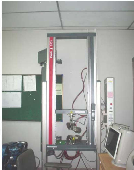
ภาพที่ ค.16 เครื่องทดสอบดึงถูงมือตัวอย่าง Universal testing Machine
