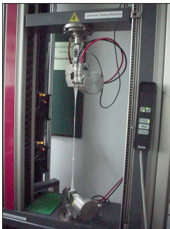
ภาพ ก.16 การทดสอบคุณสมบัติของถุงมือยางหลังการอบวัลคาไนซ์ 10 ชั่วโมง
