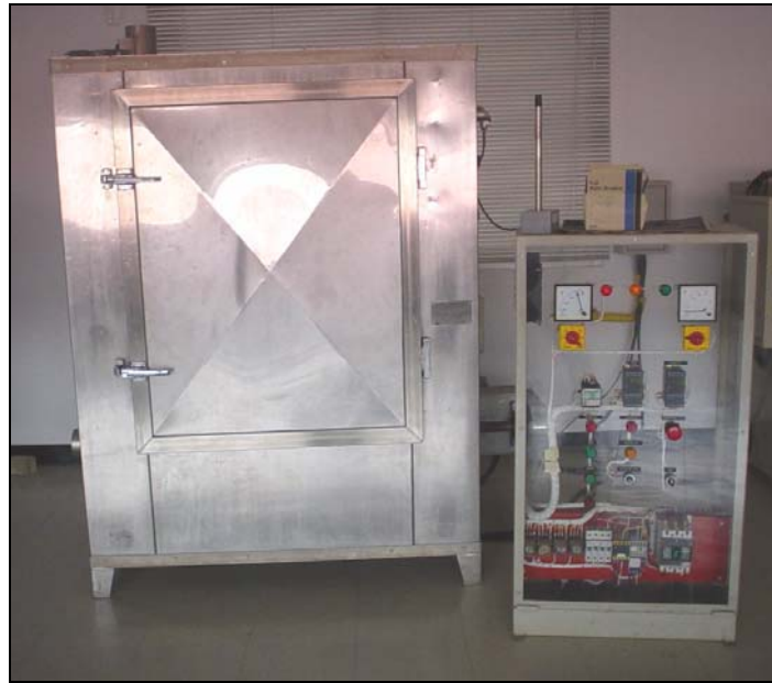
ภาพที่ ก.5 เครื่องอบแบบลมร้อนร่วมกับการบังคับอากาศของบริษัท เทคนิคคอลเทรต จำกัด ความเร็วลม 1 เมตรต่อวินาที
