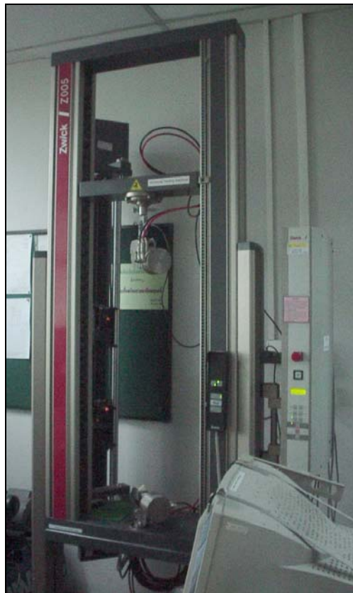
ภาพที่ ก.14 เครื่องมือวัดความแข็งแรง ยี่ห้อ Zwick รุ่น Z005
