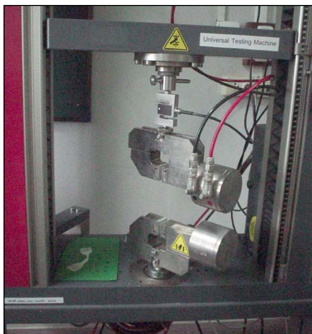
ภาพที่ ก.15 ที่จับยาง (Grips) แบบขันแน่นโดยอัตโนมัติ
