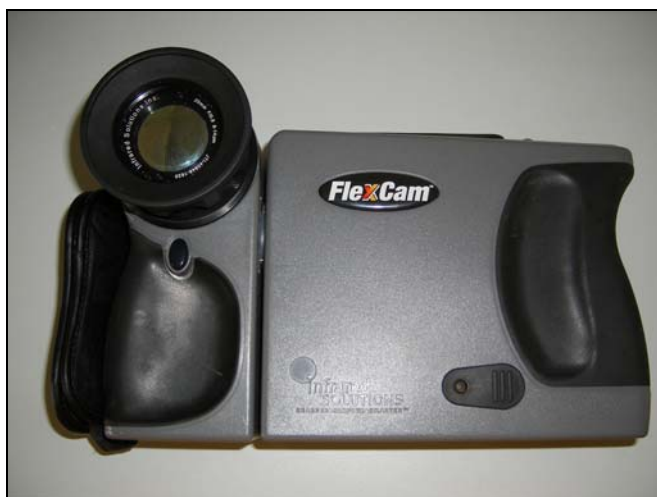
ภาพ ก.18 เครื่องวัดค่าความร้อน ยี่ห้อ Infrared Solutions รุ่น IR-FLEXCAM™-T
