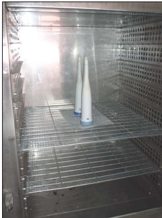
ภาพที่ ก.6 การอบวัลคาไนซ์ยางด้วยลมร้อนร่วมกับการบังคับอากาศ
