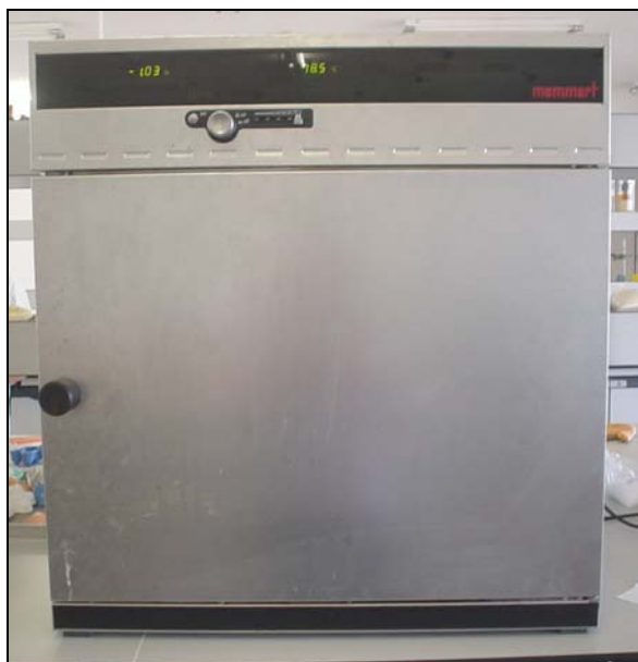
ภาพที่ ก.7 เครื่องอบวัลคาไนซ์ยางด้วยลมร้อนแบบอิสระ ยี่ห้อ Memmert
