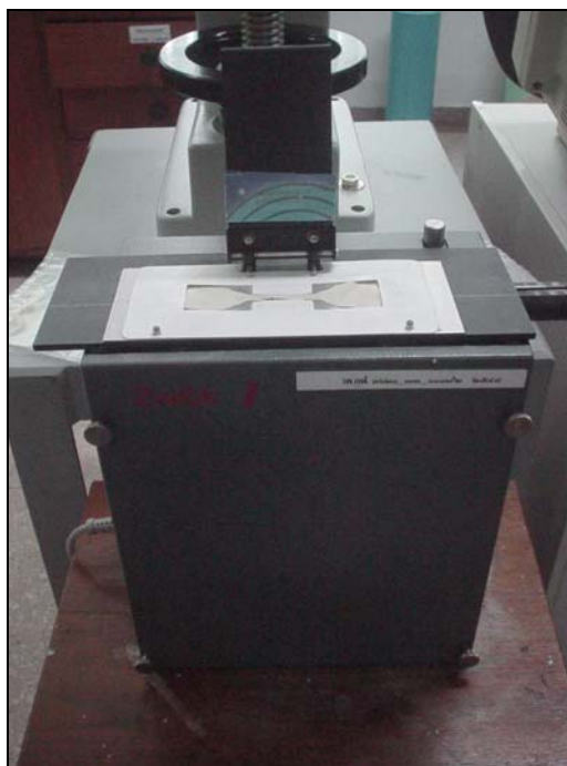
ภาพที่ ก.13 อุปกรณ์สำหรับทำเครื่องหมายบนชิ้นทดสอบ (Specimen marking device) ยี่ห้อ Zwick รุ่น B066921
