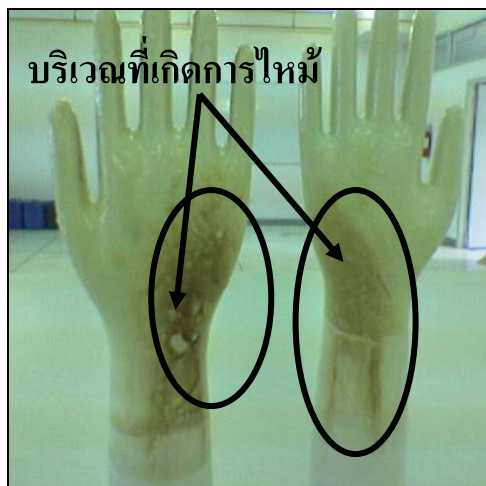
ภาพที่ ก.11 ตัวอย่างการไหม้ของถุงมือยางภายหลังการอบวัลคาไนซ์ด้วยอินฟราเรด
