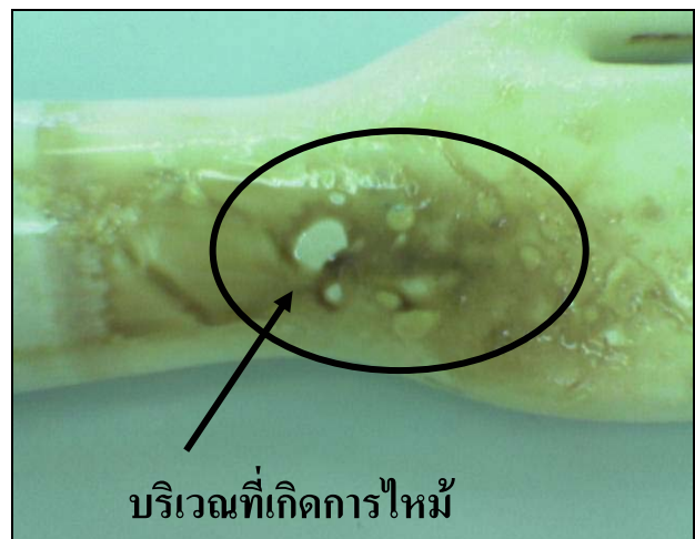
ภาพที่ ก.11 ตัวอย่างการไหม้ของถุงมือยางภายหลังการอบวัลคาไนซ์ด้วยอินฟราเรด
