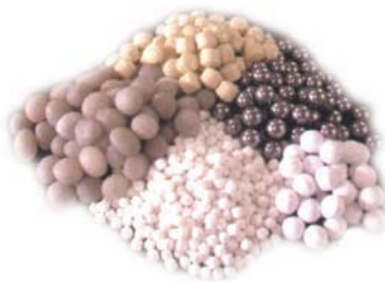
ภาพที่ 4 ลูกบดขนาดต่าง ๆ เพื่อเพิ่มประสิทธิภาพในการบด [5]
