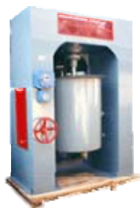
ภาพที่ 5 เครื่องบดแบบเอทริเตอร์ [6] และหลักการทำงานของเครื่องเอทริเตอร์ [9]
