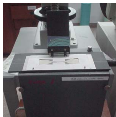
ภาพที่ ก.13 อุปกรณ์สำหรับทำเครื่องหมายบนชั้นทดสอบ (Specimen marking device)
