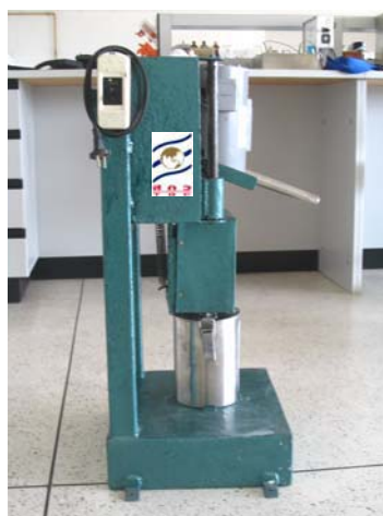
ภาพที่ ก.1 เครื่องคิสเพอร์ชั้นมิลด้านหน้า ด้านบน ด้านข้าง และด้านหลัง
