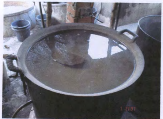
ใช้กระบะบรรจุน้ำเพื่อการกลั่นตัวเป็นหยดน้ำ
