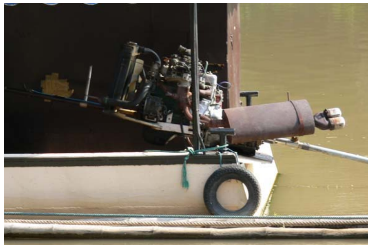
ภาพที่ 4.52 แสดงเครื่องยนต์เรือไฟหม้อพัก
