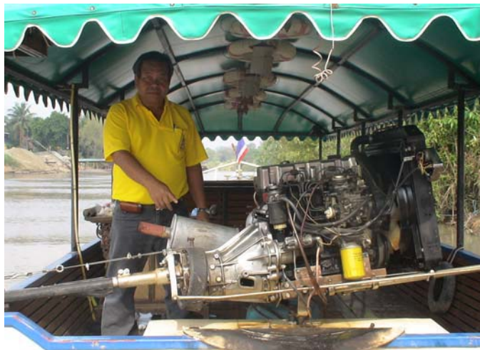
ภาพที่ 4.49 แสดงเครื่องยนต์เรือไส้หม้อพัก
