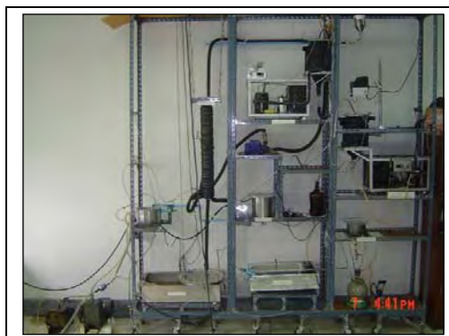
ภาพ ค.5 เครื่องสกัดแคโรทีนอยด์จากน้ำมันปาล์มดิบ
