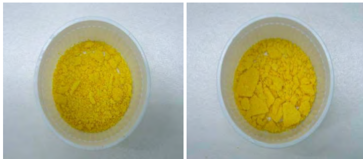
ภาพ ค.38 แคโรทีนอยด์แห้งรูปอิมัลชัน ที่อุณหภูมิ 30 องศาเซลเซียส ที่ระดับความชื้นสัมพัทธ์ 90% ก่อนเก็บรักษา (ซ้าย) และหลังเก็บรักษา (ขวา) เป็นเวลา 3 เดือน
