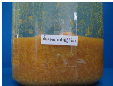
ภาพ ข-14 ขั้นตอนการทำปฏิกิริยาในกระบวนการสะปอนิฟิเคชัน
