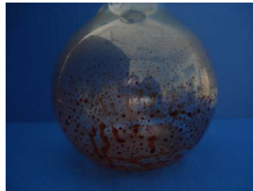
ภาพ ข-20 สารสกัดแคโรทีนอยด์หลังจากระเหยเฮกเซนออกด้วยระบบสุญญากาศ
