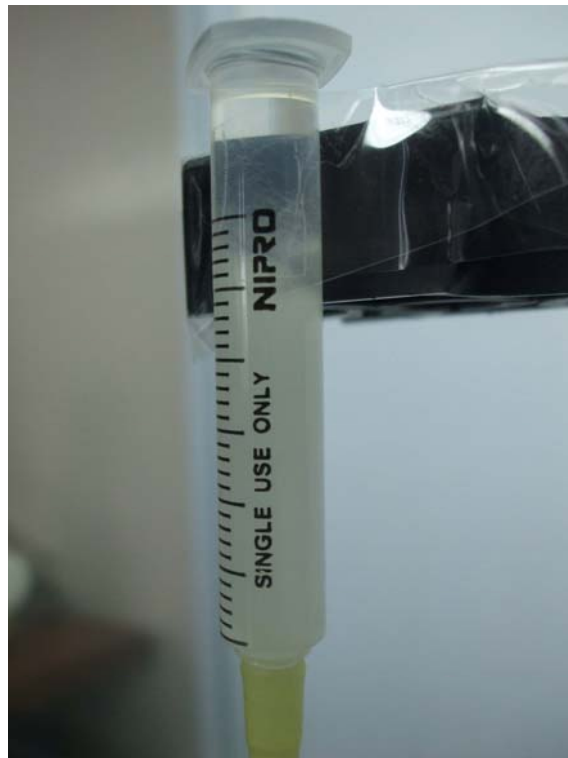
รูปที่ 4 column ที่ใช้แยก sporozoites ซึ่งดัดแปลงจากหลอดฉีดยาขนาด 3 มล. โดยการบรรจุ nylon wool และ DEAE-cellulose ไว้ภายใน
