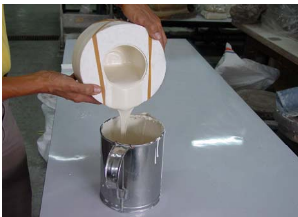
รูปแสดงการเทน้ำดินออกจากแบบพิมพ์เมื่อได้ ความหนาตามความต้องการ
