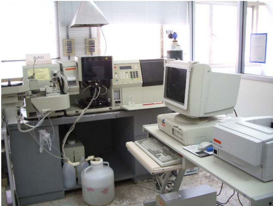
รูปที่ 6 เครื่องอะตอมมิกแอปซอพชั่นยี่ห้อ Perkin Elmer รุ่น AAnalyst 100 พร้อมคอมพิวเตอร์ควบคุมการทำงาน
