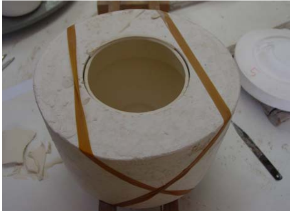
รูปแสดงการตั้งแบบพิมพ์ทิ้งไว้เพื่อให้ชิ้นงานแห้ง และร่อนออกจากแบบพิมพ์
