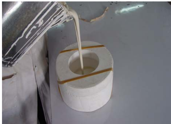
รูปแสดงการเทน้ำดินลงในแบบพิมพ์ปูนปลาสเตอร์
