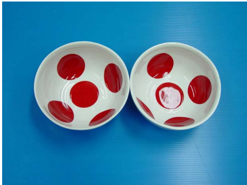
รูปแสดงภาชนะที่ผ่านการเผาแล้วสำหรับนำไปทดสอบหาปริมาณตะกั่วและแคดเมียม
