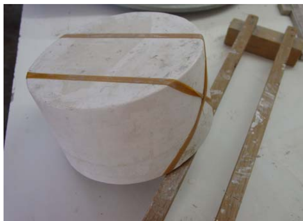
รูปแสดงการคว่ำแบบพิมพ์ทิ้งไว้เพื่อ ให้น้ำดินไหลออกจนหมด
