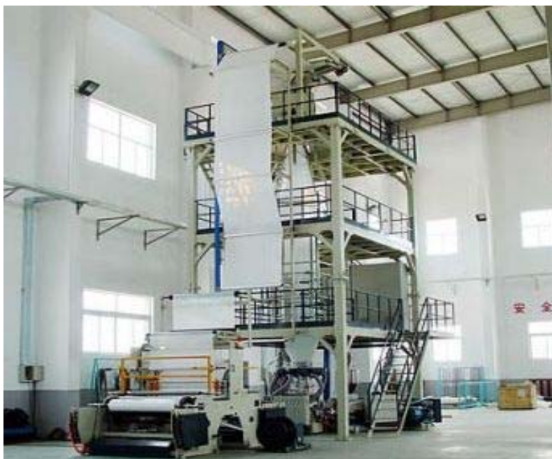
ภาพที่ 4-11 เครื่อง blown film co-extrusion 3 layers ที่ใช้ผลิต LLDPE
