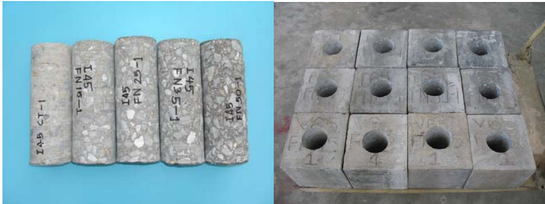
รูปที่ 3.12 คอนกรีตที่ได้จากการเจาะ
