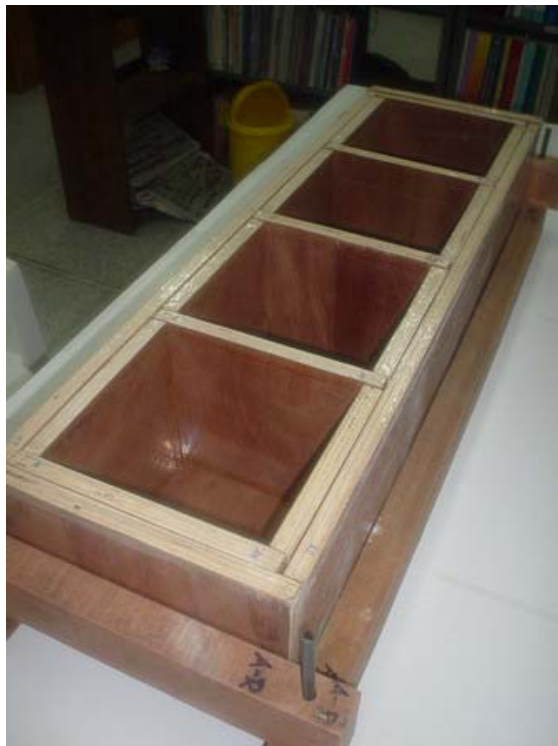
รูปที่ 3.6 แบบหล่อตัวอย่างคอนกรีตรูปทรงลูกบาศก์ ขนาด 20 ซม.
