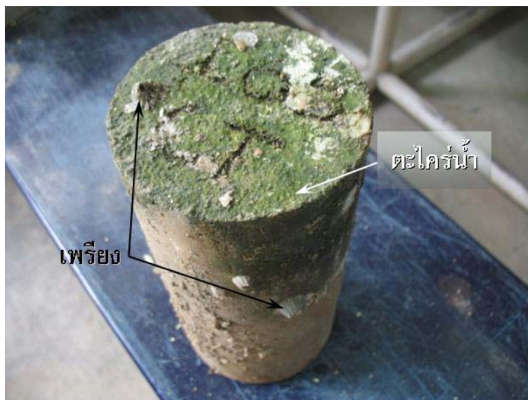
(ข) เพรียง และตะไคร่น้ำที่ติดอยู่ตามผิวคอนกรีต
